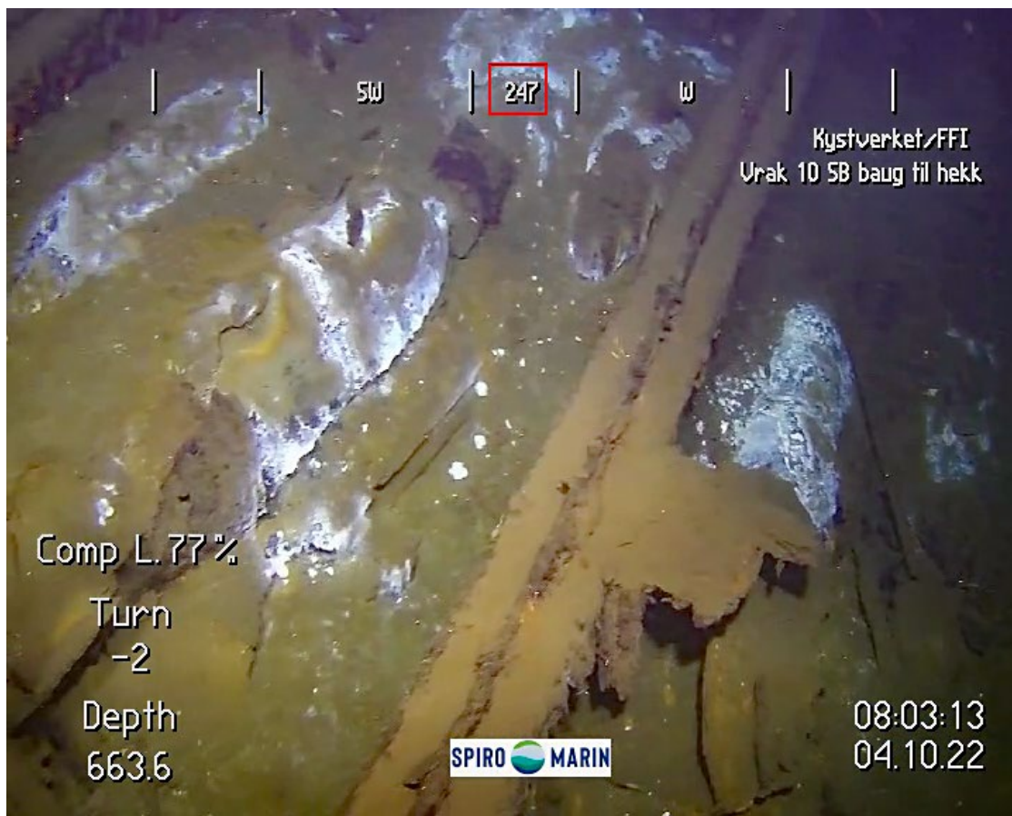
Figur 4.18 Bomber på vrak nr. 10 belagt med et hvitt belegg som sannsynligvis er mikroorganismer. (Bilde: Spiro Marine).
