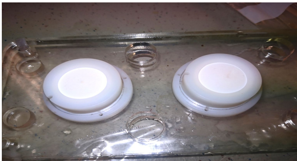
Figur 6.10 Passive prøvetakere for absorpsjon av metaller etter 51 uker i sjøen ved vrak nr. 13. (Bilde: FFI).
