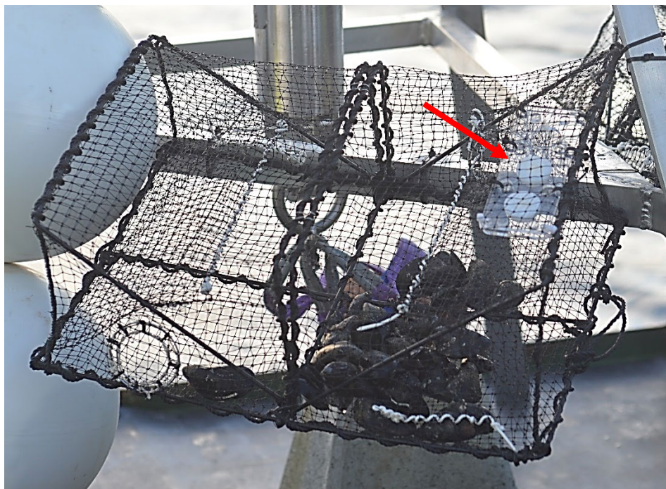
Figur 3.8 Passive prøvetakere for metaller (LSNT og LSMN) markert med rød pil i teinene med blåskjell. (Bilde: FFI).
