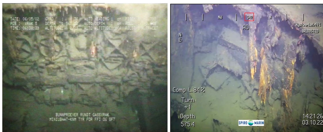
Figur 4.5 Videobilder fra stedet på vrak nr. 13 der baugen er brutt av. Bildet til venstre er fra 2002, mens bildet til høyre er fra 2022. (Bilder: KNM Tyr og Spiro Marine).
