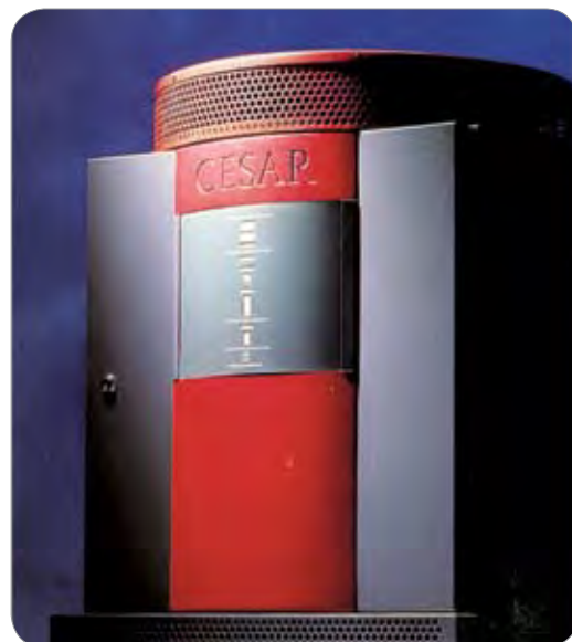
Kompakt CESAR for prosessering av SAR-data fra ERS-1/2 og RADARSAT ved TSS.
