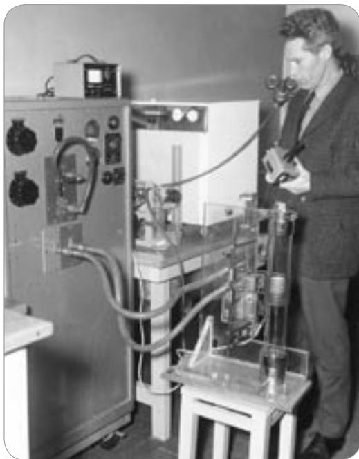
Jan Knudsen foretar utgassing av Vacometall før sammenføring til glass for fremstilling av glassmetalloverganger 1967.
