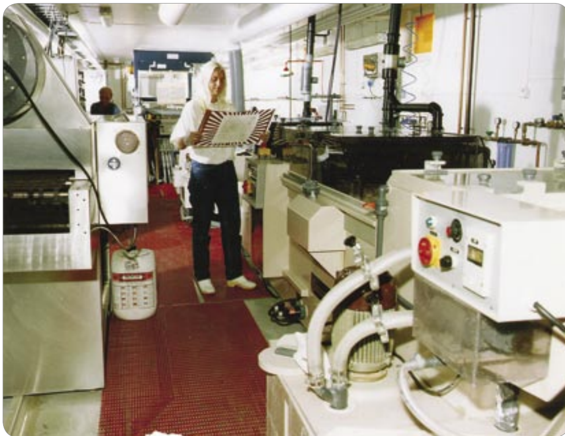
Fra etse- og pletteringslinjen. Laila Trosdahl-Iversen med ferdig innerlag for flerlagskort.
