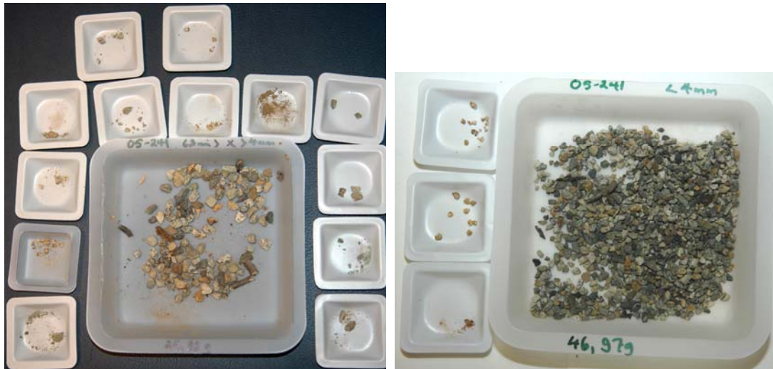
Figur 4.7 Utvalgte partikler fra prøve 05-241 som skal undersøkes om de er eksplosiver. Bildet til venstre viser fraksjonen mellom 4 og 6,3 mm, mens de partiklene som er mistenkt å være eksplosivpartikler er samlet i de små plastbegrene. Bildet til høyre viser det samme for fraksjonen under 4 mm.
