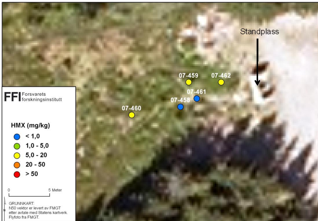
Figur 4.2 Oversikt over konsentrasjonsnivåer av HMX på standplass i en panservernbane i Steinsjøen skyte- og øvingsfelt.
