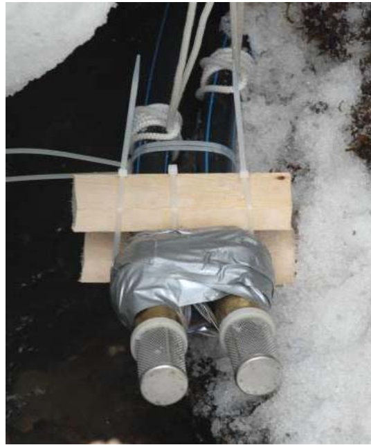
Figur 2.2 Graving av kanal i snøen for nedlegging av slanger fra bekken til prøvestasjonen til venstre, og plastslangene med påmonterte metallsiler til høyre.
