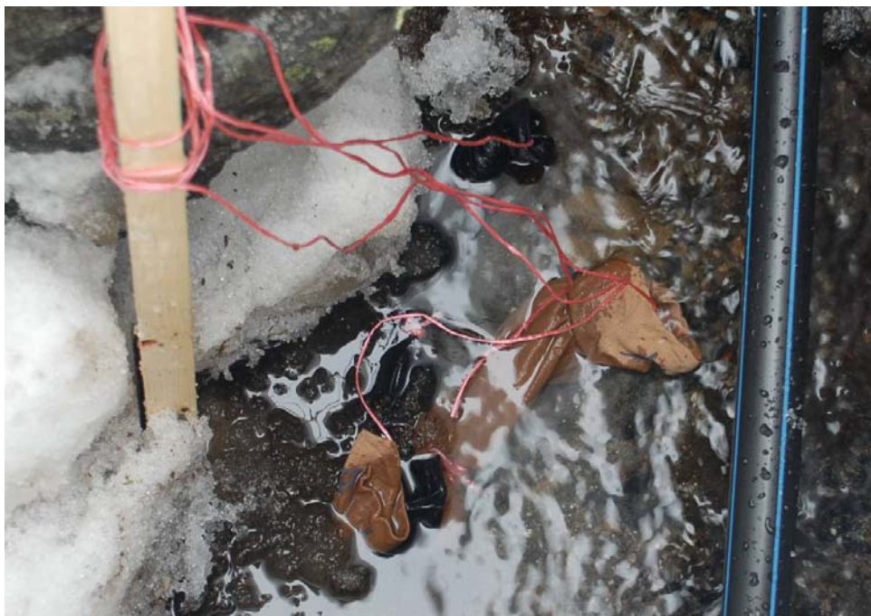
Figur 2.5 Eksplosivklumper som er lagt ned i bekken, pakket inn i tesil og nylonstrømper.
