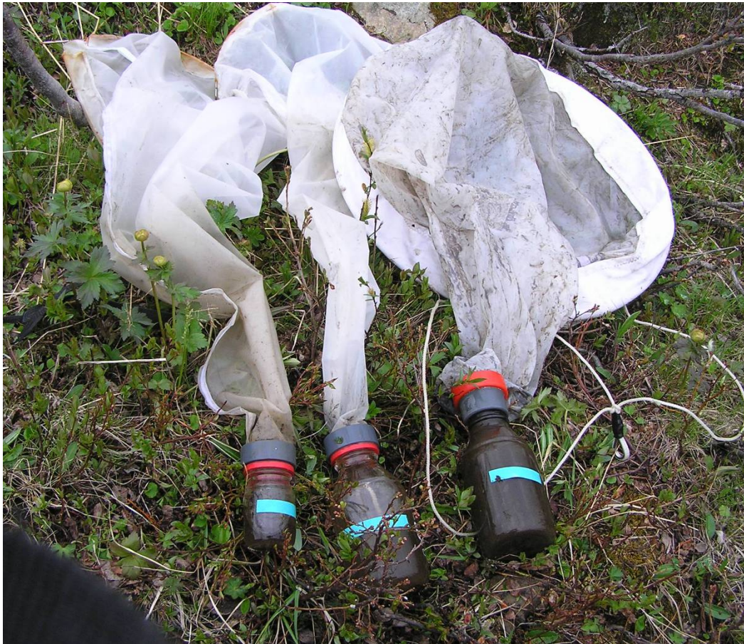
Figur 3.3 Planktonhåver ved forsøkets slutt med påmonterte oppsamlingsflasker for partikler.
