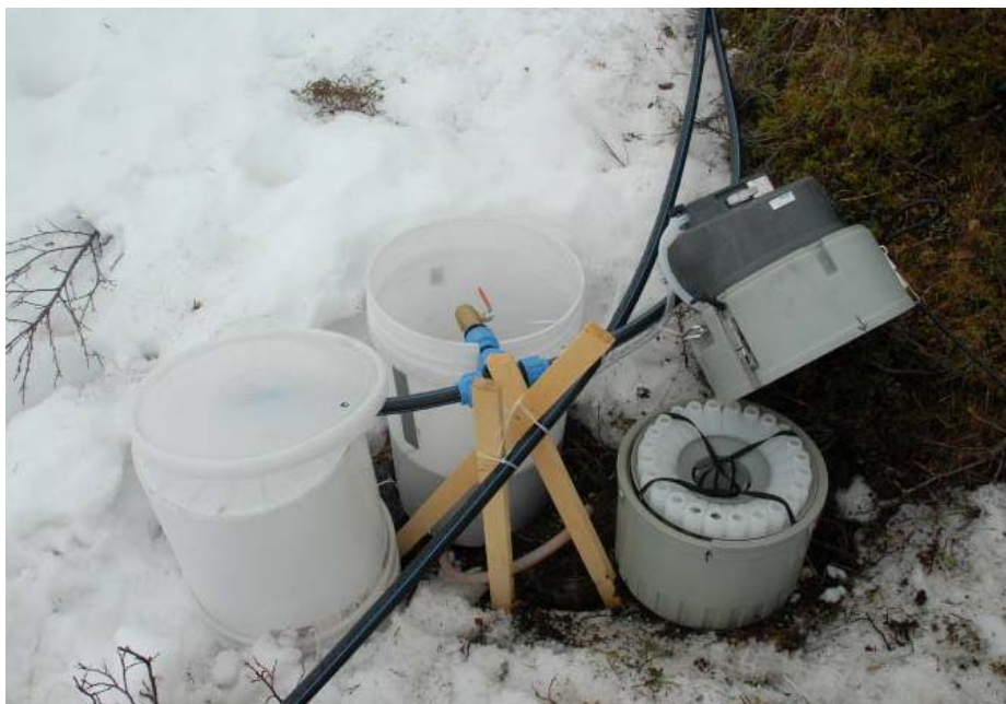
Figur 2.4 ISCO automatisk vannprøvetaker og de to hvite plastdunkene hvor det var plassert sandfilter og sikter.
