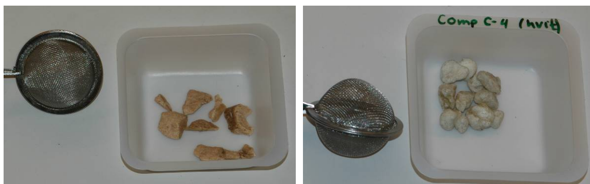
Figur 3.2 Eksplosivklumper som har ligget i bekken, TNT til venstre og C-4 til høyre.
