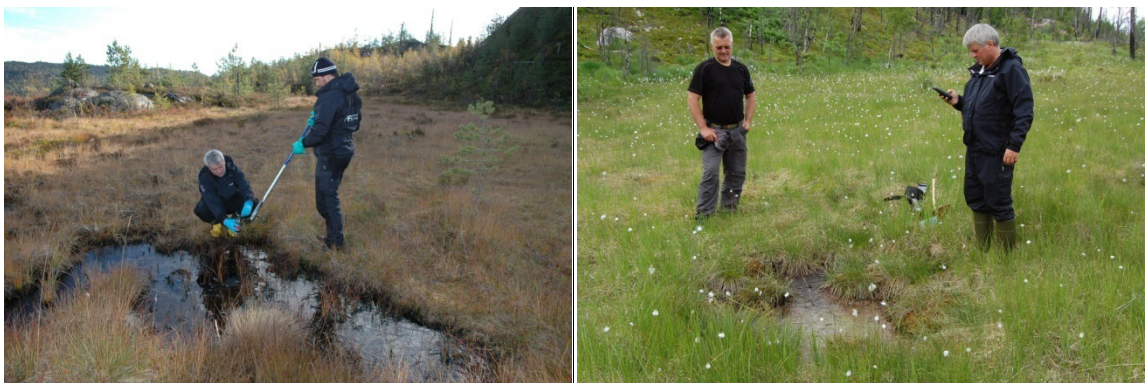
Figur 2.4 Eksempel på prøvetatte kratre som ble mistenkt å kunne være forårsaket av fosforgranater. Foto: Forsvarsbygg og FFI.
