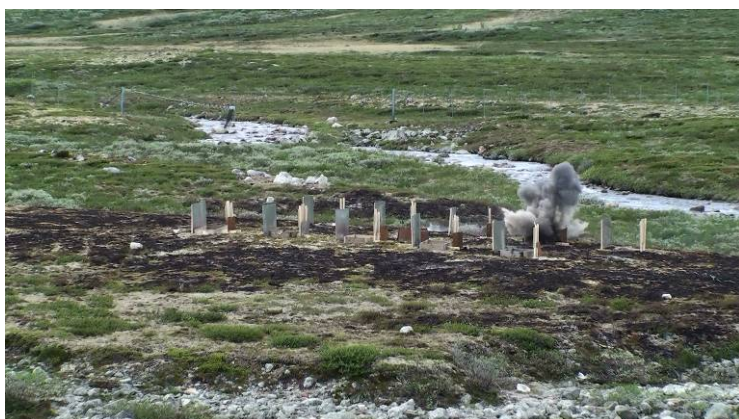
Figur A.5: Bildesekvens som viser omsetningsforløpet til en blindgjønger av typen 20 mm MP som er 1-2 cm nedgravd i tørr sand, og som bli oppvarmet av en engangsgrill.
