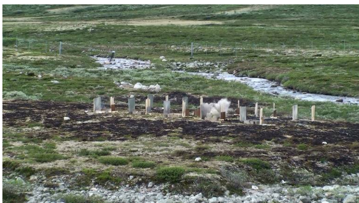
Figur A.3: Bildesekvens som viser omsetningsforløpet til en blindgjenger av typen 12,7 mm MP som var 1-2 cm nedgravd i tørr sand, og som bli oppvarmet av en engangsgrill. Dette forløpet viser at omsetningen muligens er av lavere orden hvis man sammenligner med Figur A.2.
