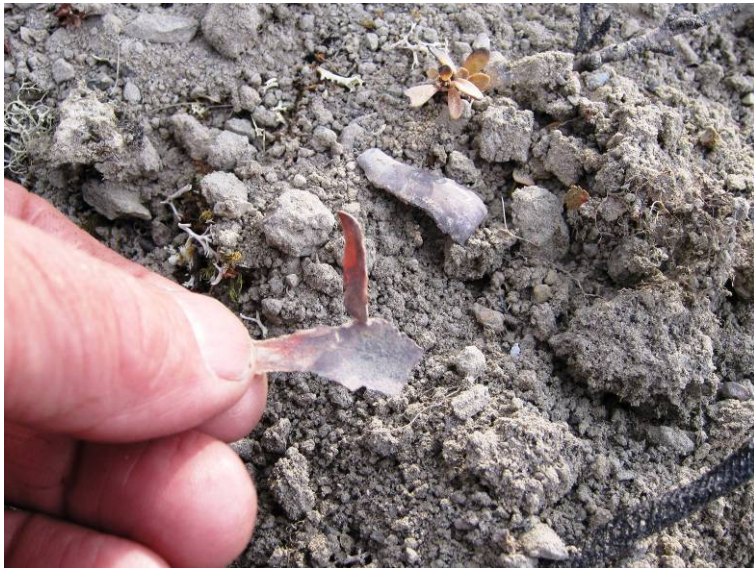
Figur 6.18: Eksempel på fragmenter funnet etter antatt høyordens omsetning. Denne er fra Ch 6.
