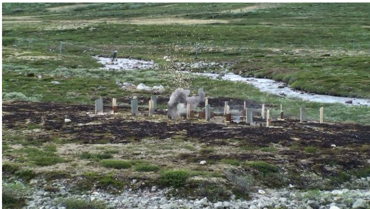
Figur A.2: Bildesekvens som viser omsetningsforløpet til en blindjenger av typen 12,7 mm MP som er 1-2 cm nedgravd i tørr sand, og som bli oppvarmet av en engangsgrill.
