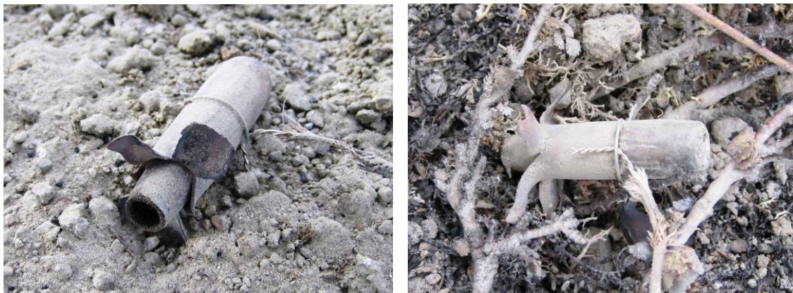
Figur 6.17: Restene av prosjektilet som ble funnet i to av fem tester der blindgjengerne var nedgravd i grus med 1-2 cm overdekning. Venstre bilde fra Ch 3 og høyre bilde fra Ch 5.
