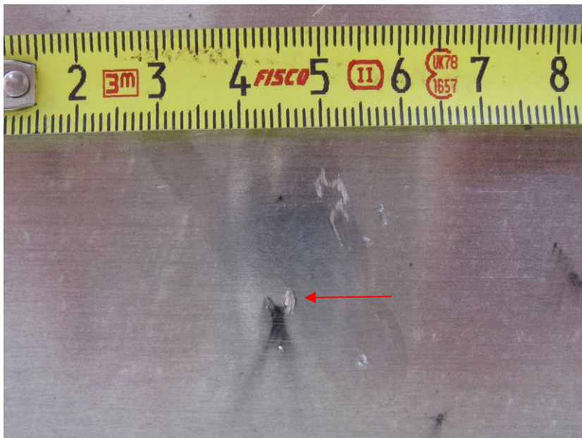
Figur 6.25: Overflateskade i vitneplate av 2 mm tykk aluminium. Vitneplaten tilhører oppsettet til Ch 8.
