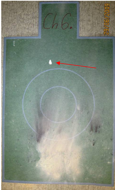
Figur 6.20: Perforering gjennom vitneplate av papp i oppsett navngitt Ch 6.
