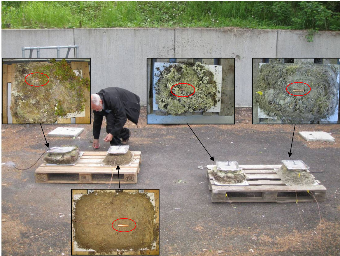
Figur 5.1: Testing av jordsmonn og vegetasjonstyper. De fire oppsettene er (fra venstre): Prosjektil i vegetasjon av lyng og gress; tre prosjektiler i forskjellige dybder i fuktig jord; prosjektil i vegetasjon av mose; og tre prosjektiler i forskjellige dybder av tørr grus og jordblanding. Bildet viser også hvordan engangsgrillene tennes opp ved bruk av tjærelunte. Innfelte bilder viser prosjektilenes plassering, med unntak av de nedgravd i jordsmonnet.
