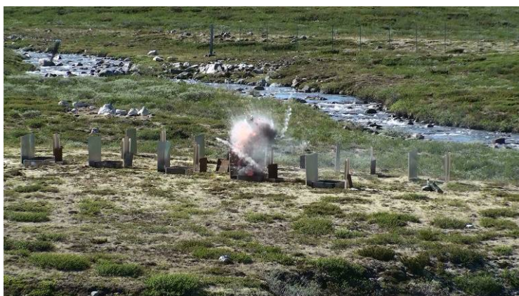
Figur A.1: Bildesekvens som viser omsetningsforløpet til en blindgjenger av typen 12,7 mm MP lagt i vegetasjon av lyng og mose, og som bli oppvarmet av en engangsgriil.
