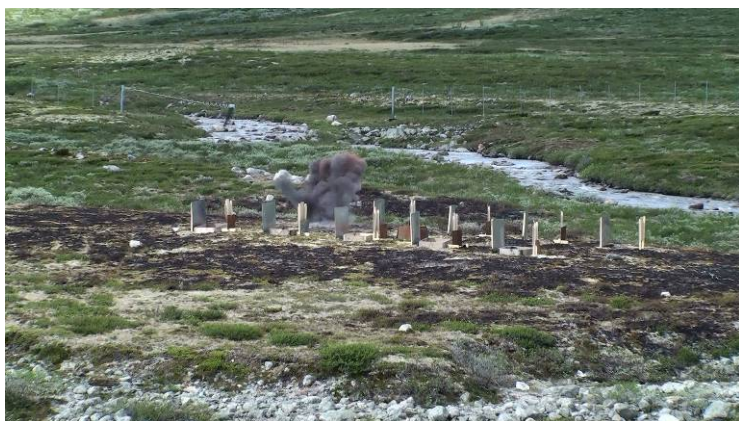
Figur A.4: Bildesekvens som viser omsetningsforløpet til en blindgjønger av typen 20 mm MP delvis nedgravd i fuktig jord, og som bli oppvarmet av en engangsgrill.
