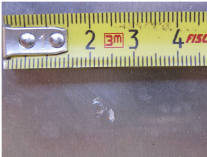
Figur 6.23: Overflateskade i vitneplate av 2 mm tykk aluminium. Vitneplaten tilhører oppsettet målt av Ch 11.
