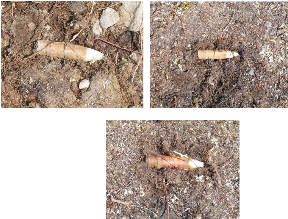
Figur 6.22: Plassering av 20 mm blindgjengere før oppfyring. Øverst til venstre: Ch 9. Øverst til høyre: Ch 10. Nederst Ch 11.
