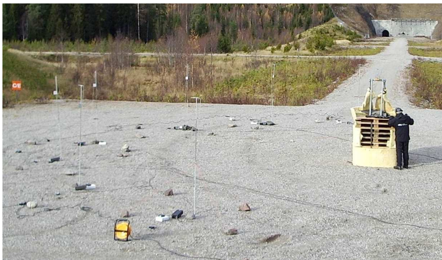
Figur 3.1: Måleoppsettet med 7 mikrofoner 10 m fra munningen.
