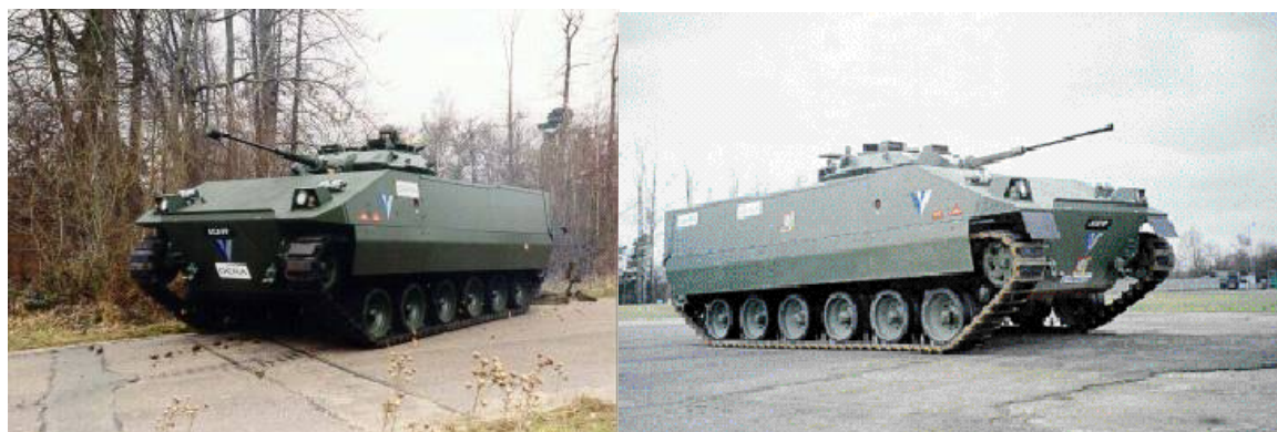
Figur 8.3 ACAVP- Advanced Composite Armoured Vehicle Platform - fra QinetiQ – med skroget bygget opp av panser basert på glassfiberkompositt (E-glass).
