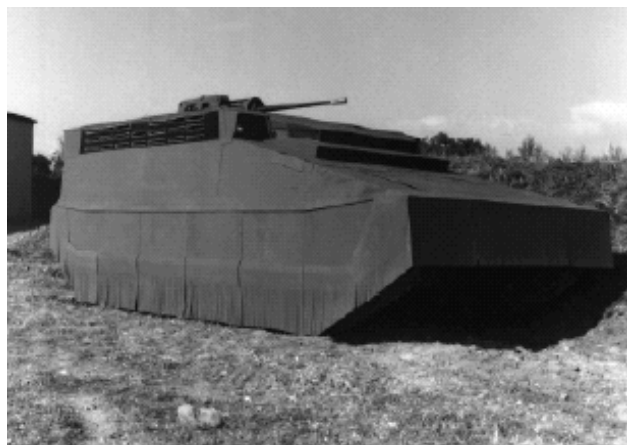
Figur 8.2 Stridskjøretøy med skrog i kompositt panser (CAV-ATD) fra United Defence.
