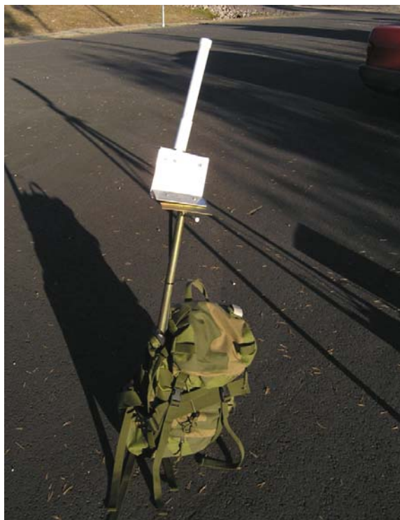
Figur 3.11 Testplattform - enkeltmann. Strømforsyning, CPE og antenne.
