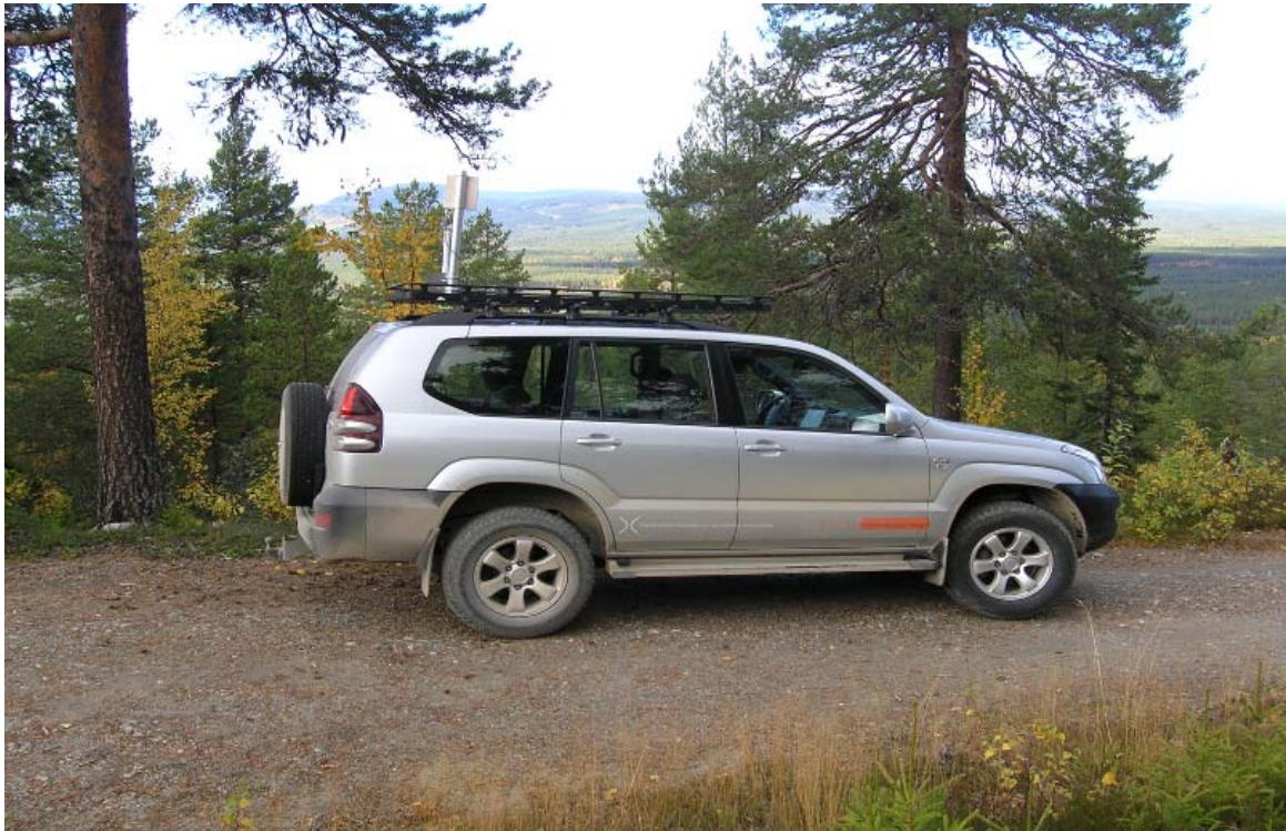
Figur 3.8 Testplattform. Personbil med antenner montert på tak.
