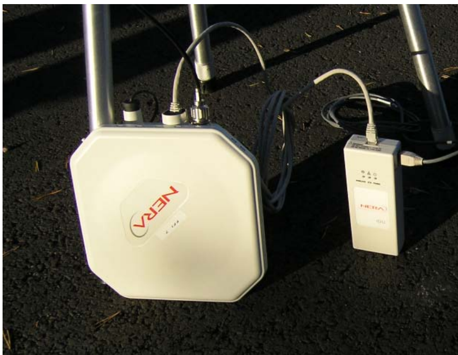
Figur 3.3 CPE. Innendørsenhet IDU (høyre) og utendørsenhet ODU (venstre).
