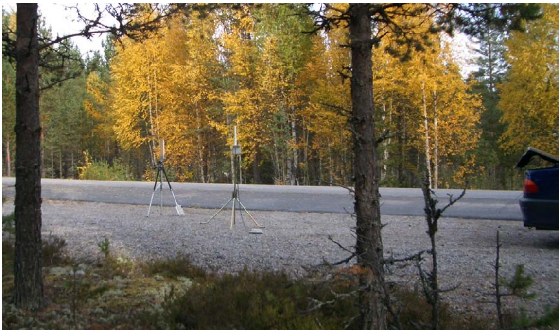
Figur 3.10 Alternativ testplattform. Antenner er ikke fastmontert på kjøretøy og må settes opp på føtter i hver posisjon.
