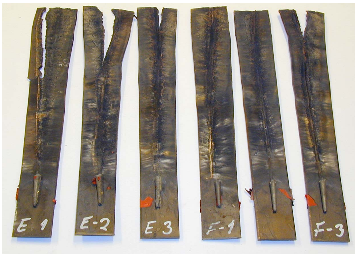
Figur 3.10 Bilde av vitneplatene og rester av sprengstoffkoner for blandingene E og F med F-HMX Ch.794/02.
