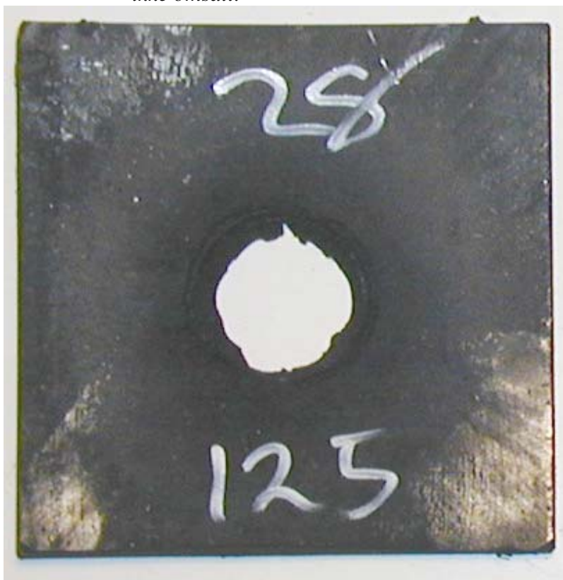
Figur 3.40 Skudd 28, rør 28 med HMX/Al PBX inneholdende F-HMX Ch. 794/02, 125 kort, omsatt.
