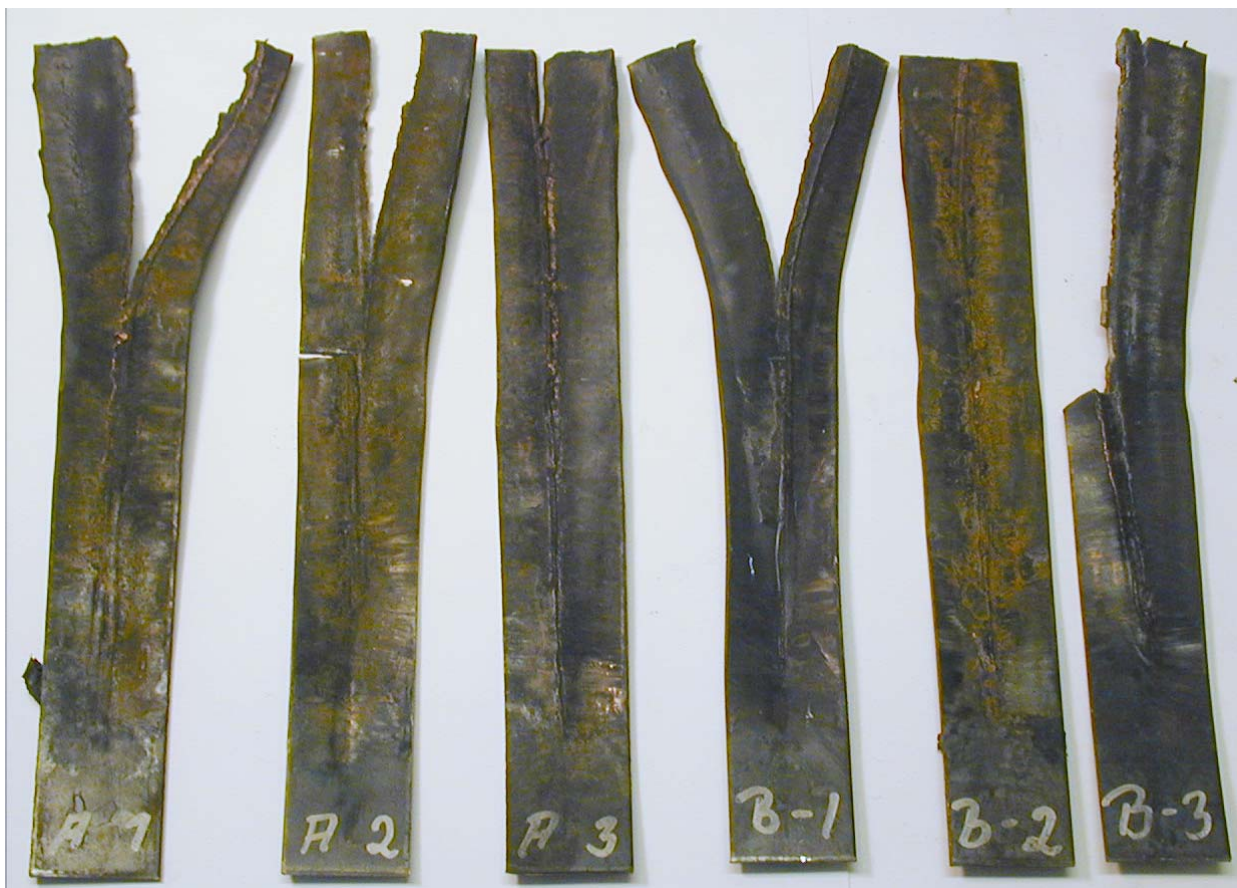
Figur 3.6 Vitneplater for skuddene av HMX/Al-PBX inneholdende HMX Ch. 63/03 klasse 1 krystaller.
