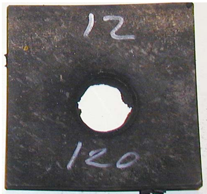
Figur 3.23 Skudd 2, rør 12 med HMX/Al PBX inneholdende F-HMX sats 105/05, 120 kort, omsatt.
