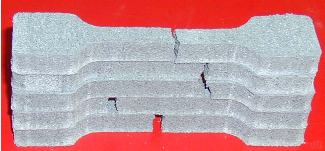
Figur 3.50 Bilde av strekte dog-bones for blanding D.
