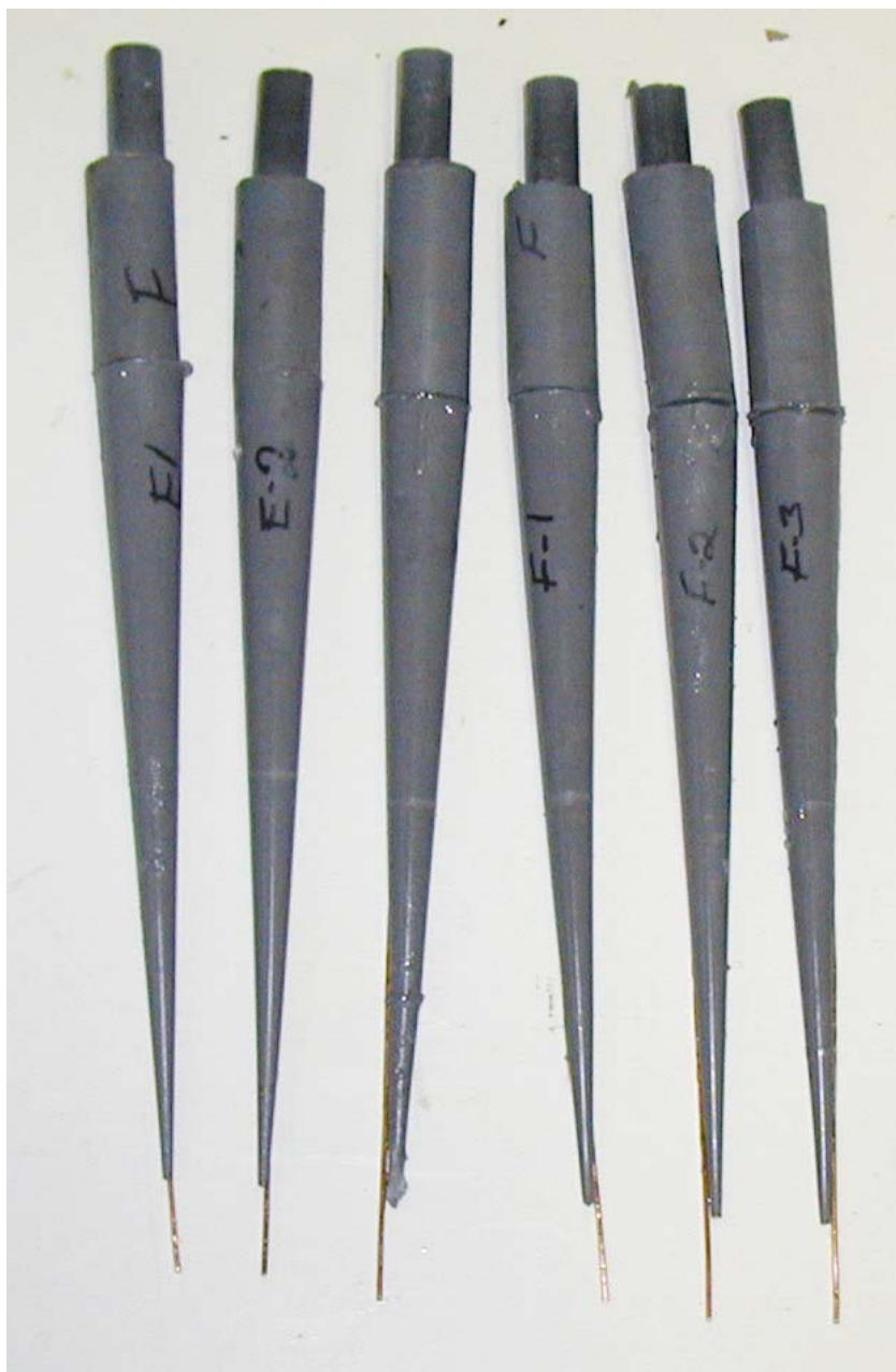
Figur 3.9 Bilde av sprengstoffkoner av HMX/Al-PBX inneholdende F-HMX Ch. 794/02 klasse I krystaller etter sammenliming og montering på vitneplatene.
