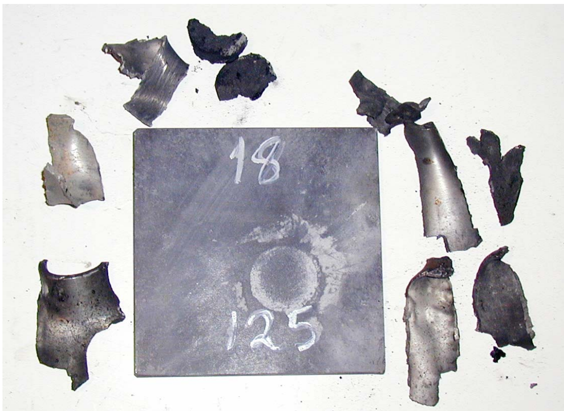
Figur 3.29 Skudd 8, rør 18 med HMX/Al PBX inneholdende F-HMX sats 105/05, 125 kort, ikke omsatt.
