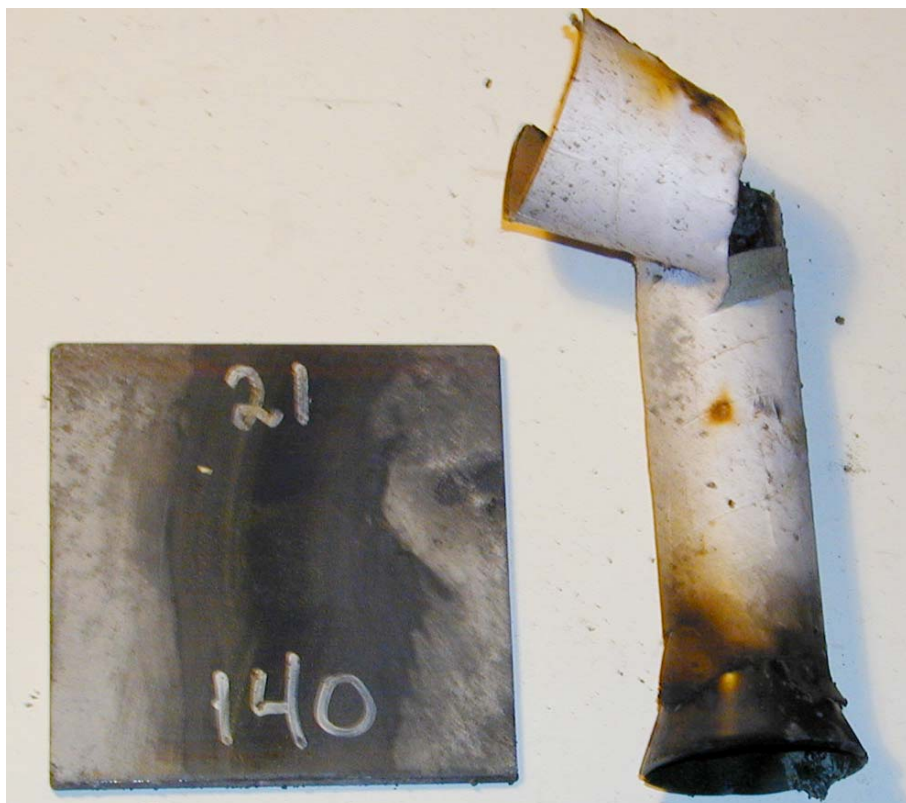
Figur 3.33 Skudd 21, rør 21 med HMX/Al PBX inneholdende F-HMX Ch. 794/02, 140 kort, ikke omsatt.
