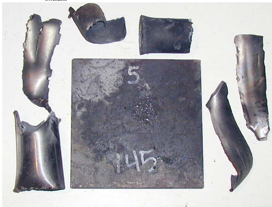
Figur 3.15 Skudd 15, rør 5 med HMX/Al PBX inneholdende HMX Ch. 63/03, 145 kort, ikke omsatt.
