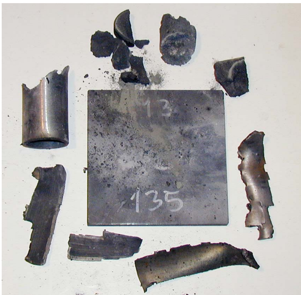
Figur 3.24 Skudd 3, rør 13 med HMX/Al PBX inneholdende F-HMX sats 105/05, 135 kort, ikke omsatt.
