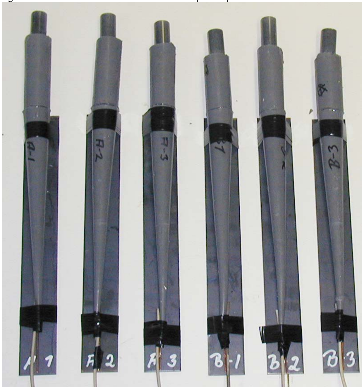
Figur 3.5 Bilde av sprengstoffkoner av HMX/Al-PBX inneholdende HMX Ch. 63/03 klasse I krystaller etter sammenliming og montering på vitneplatene.
