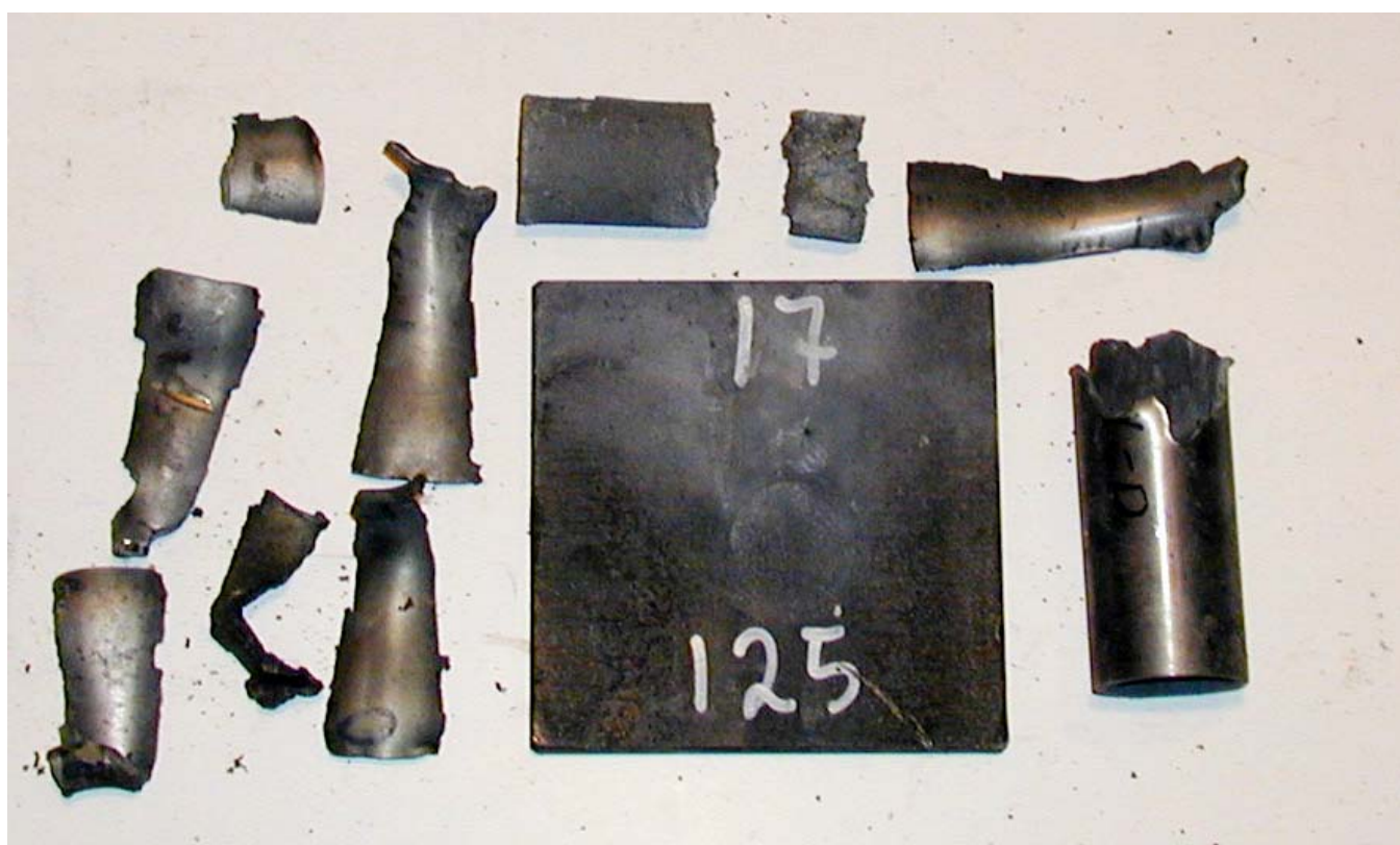
Figur 3.28 Skudd 7, rør 17 med HMX/Al PBX inneholdende F-HMX sats 105/05, 125 kort, ikke omsatt.
