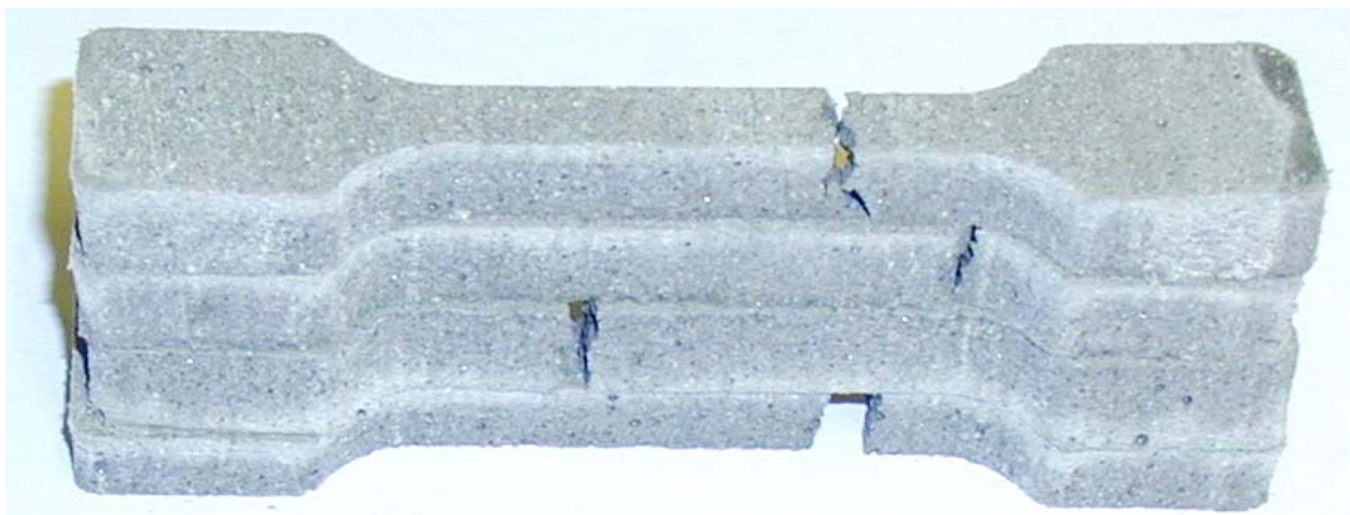
Figur 3.52 Bilde av strekte dog-bones for blanding E.
