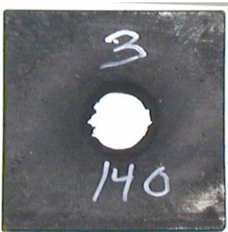
Figur 3.13 Skudd 13, rør 3 med HMX/Al PBX inneholdende HMX Ch. 63/03, 140 kort, omsatt.
