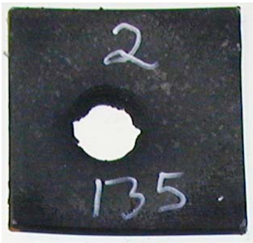
Figur 3.12 Skudd 12, rør 2 med HMX/Al PBX inneholdende HMX Ch. 63/03, 135 kort, omsatt.
