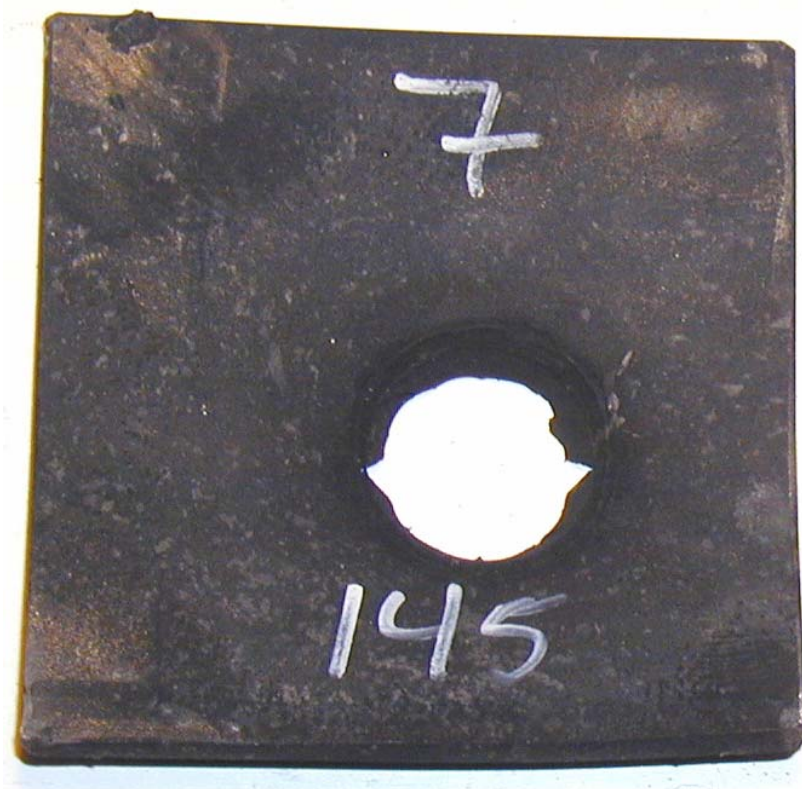
Figur 3.17 Skudd 17, rør 7 med HMX/Al PBX inneholdende HMX Ch. 63/03, 145 kort, omsatt.
