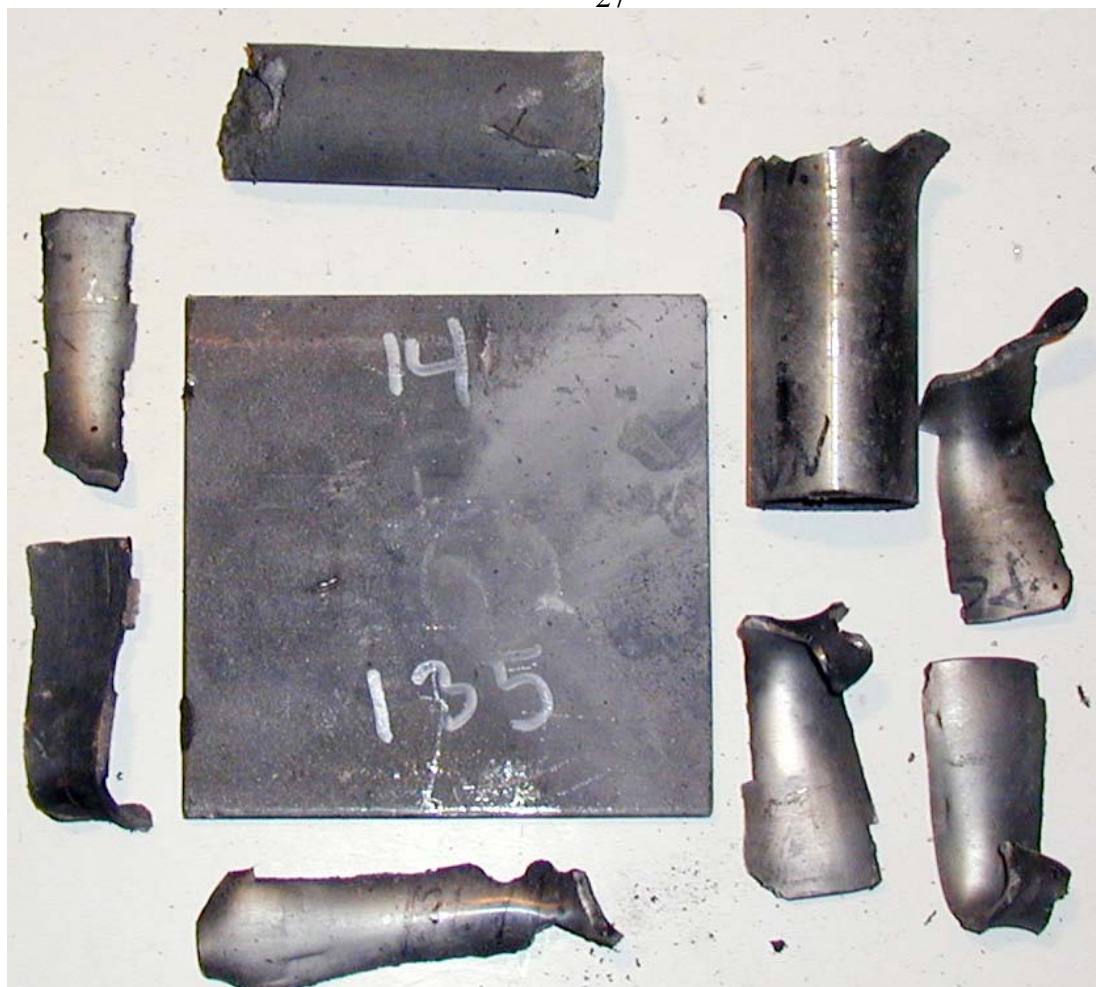
Figur 3.25 Skudd 4, rør 14 med HMX/Al PBX inneholdende F-HMX sats 105/05, 135 kort, ikke omsatt.
