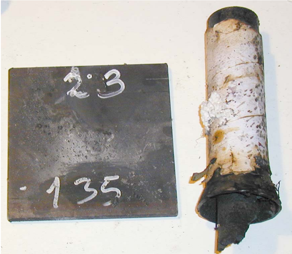
Figur 3.35 Skudd 23 rør 23 med HMX/Al PBX inneholdende F-HMX Ch. 794/02, 135 kort, ikke omsatt.
