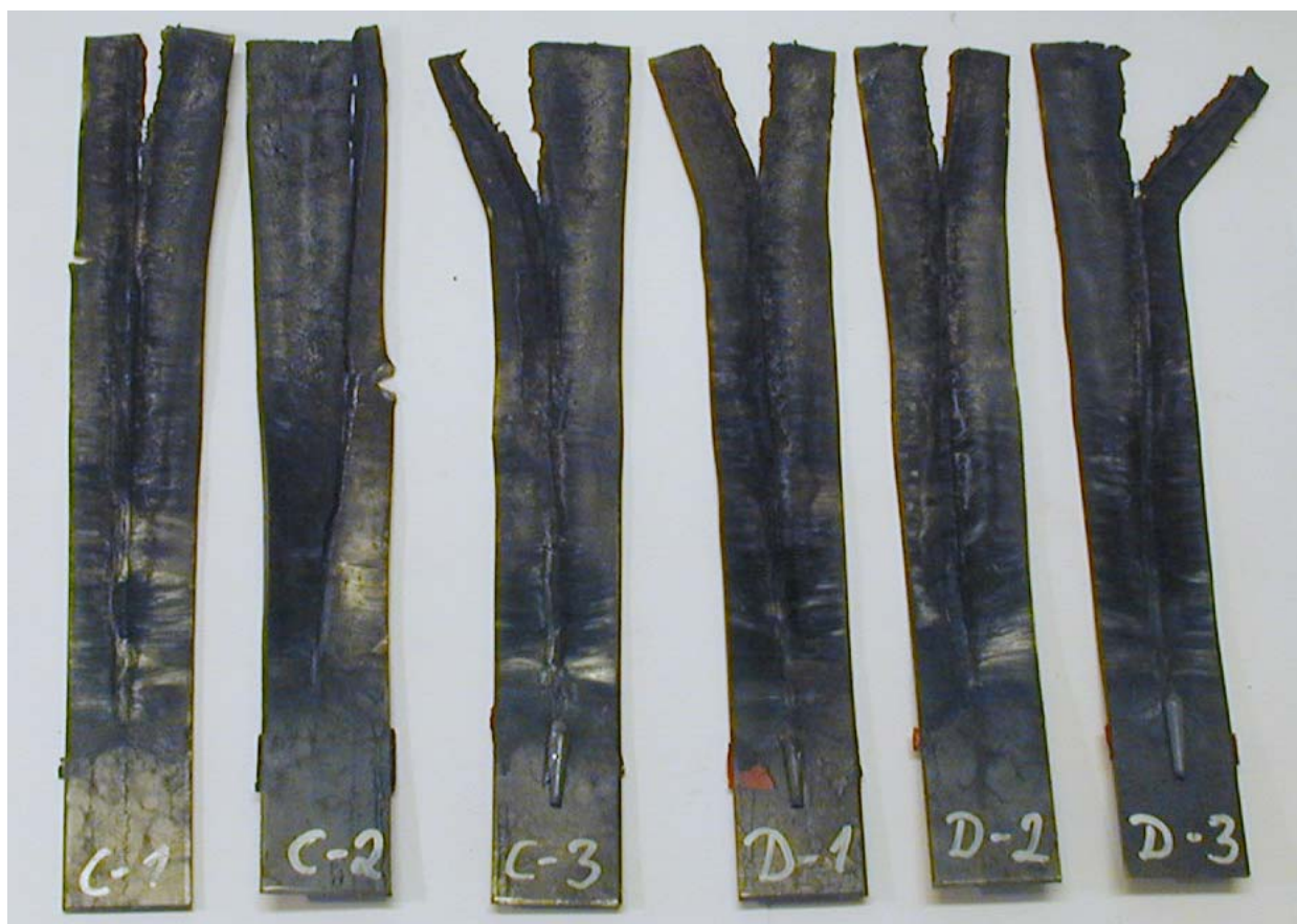
Figur 3.8 Vitneplater for skuddene av HMX/Al-PBX inneholdende F-HMX sats 105/05 klasse 1 krystaller.
