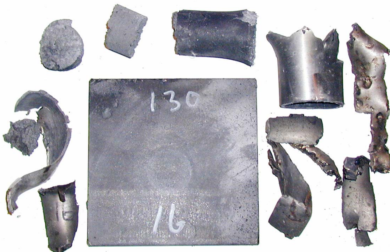
Figur 3.27 Skudd 6, rør 16 med HMX/Al PBX inneholdende F-HMX sats 105/05, 130 kort, ikke omsatt.
