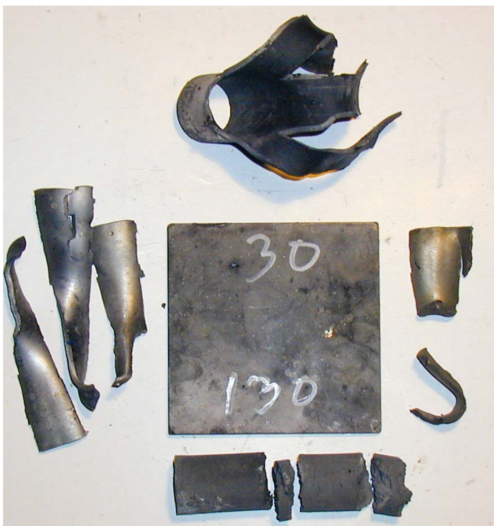
Figur 3.42 Skudd 30, rør 30 med HMX/Al PBX inneholdende F-HMX Ch. 794/02, 130 kort, ikke omsatt.
