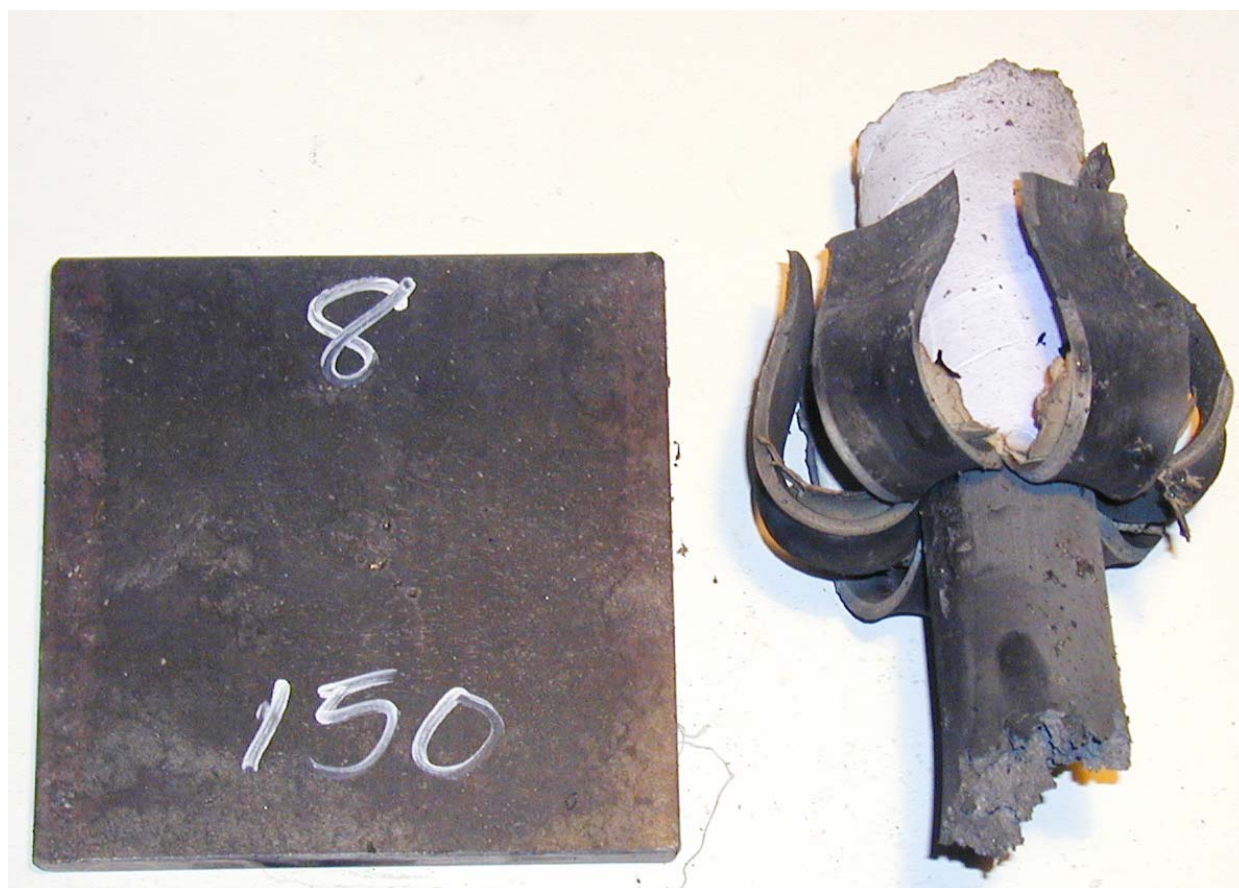
Figur 3.18 Skudd 18, rør 8 med HMX/Al PBX inneholdende HMX Ch. 63/03, 150 kort, ikke omsatt.
