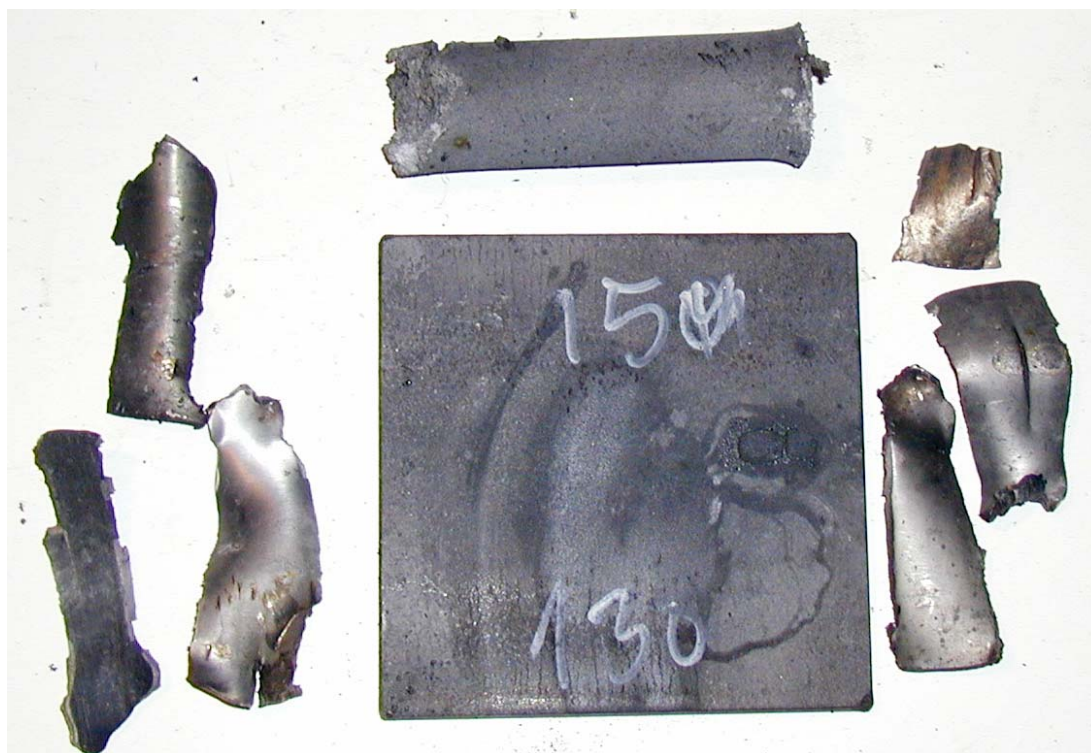
Figur 3.26 Skudd 5, rør 15 med HMX/Al PBX inneholdende F-HMX sats 105/05, 130 kort, ikke omsatt.
