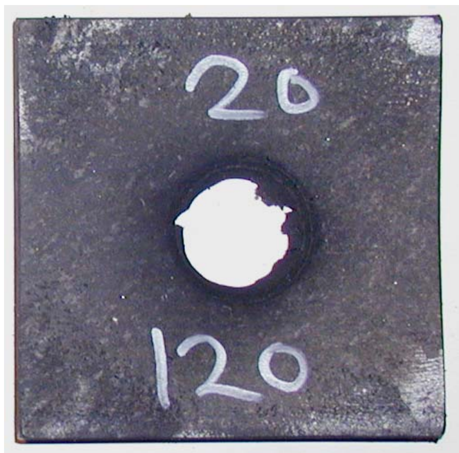
Figur 3.31 Skudd 10, rør 20 med HMX/Al PBX inneholdende F-HMX sats 105/05, 120 kort, omsatt.
