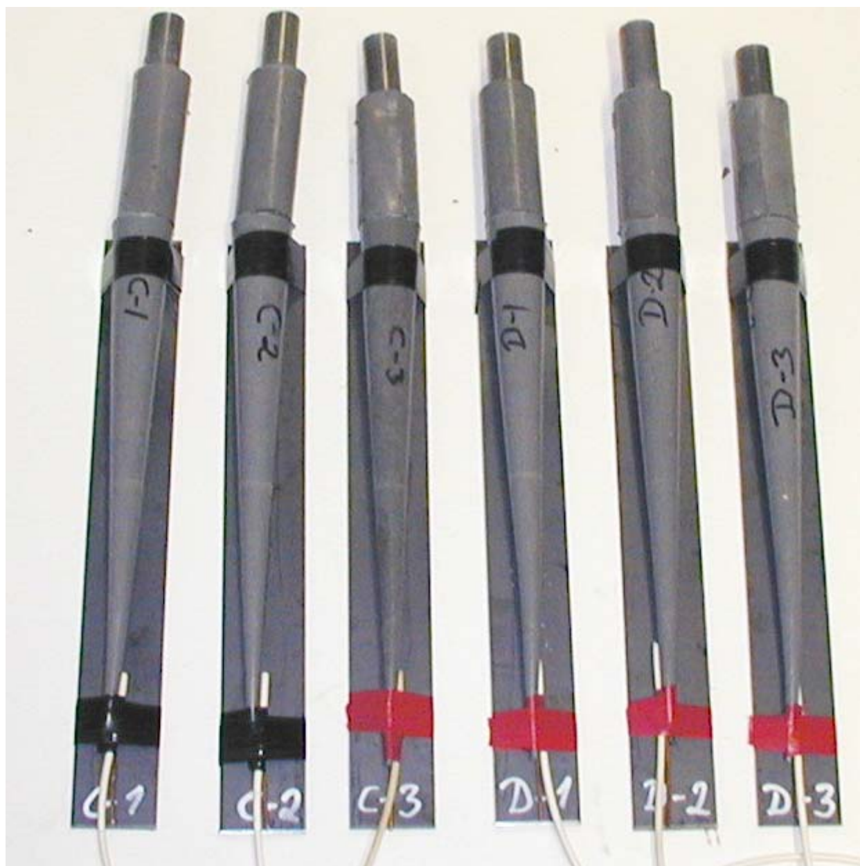
Figur 3.7 Bilde av sprengstoffkoner av HMX/Al-PBX inneholdende F-HMX sats 105/05 klasse 1 krystaller etter sammenliming og montering på vitneplatene.
