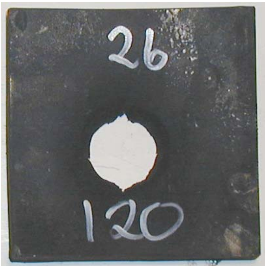
Figur 3.38 Skudd 26, rør 26 med HMX/Al PBX inneholdende F-HMX Ch. 794/02, 120 kort, omsatt.
