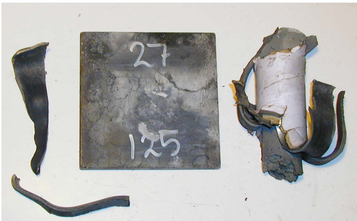
Figur 3.39 Skudd 27, rør 27 med HMX/Al PBX inneholdende F-HMX Ch. 794/02, 125 kort, ikke omsatt.
