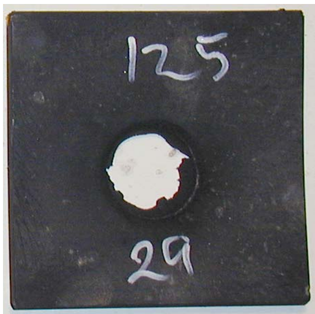
Figur 3.41 Skudd 29, rør 29 med HMX/Al PBX inneholdende F-HMX Ch. 794/02, 125 kort, omsatt.
