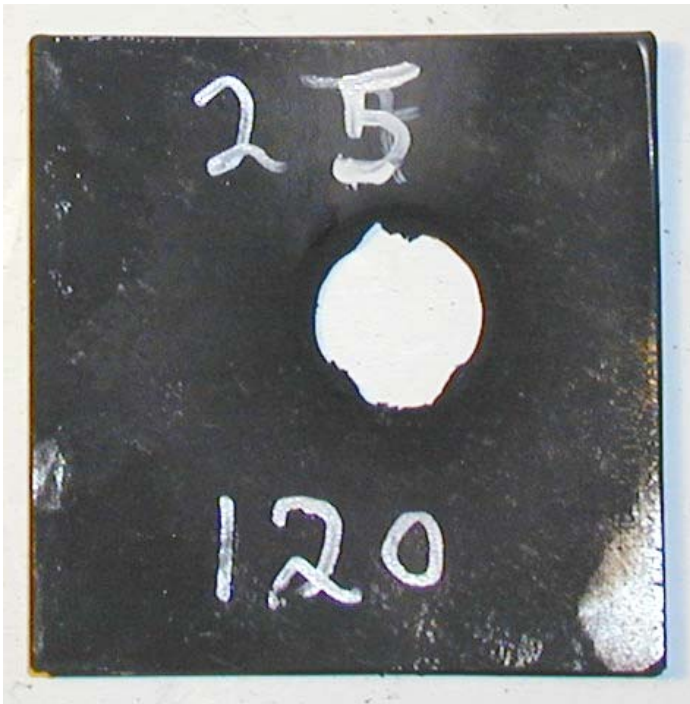
Figur 3.37 Skudd 25, rør 25 med HMX/Al PBX inneholdende F-HMX Ch. 794/02, 120 kort, omsatt.
