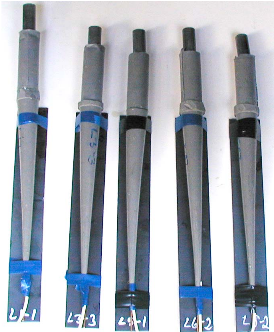
Figur 3.8 Bilde av testlegemene benyttet til bestemmelse av kritisk diameter før testing.
