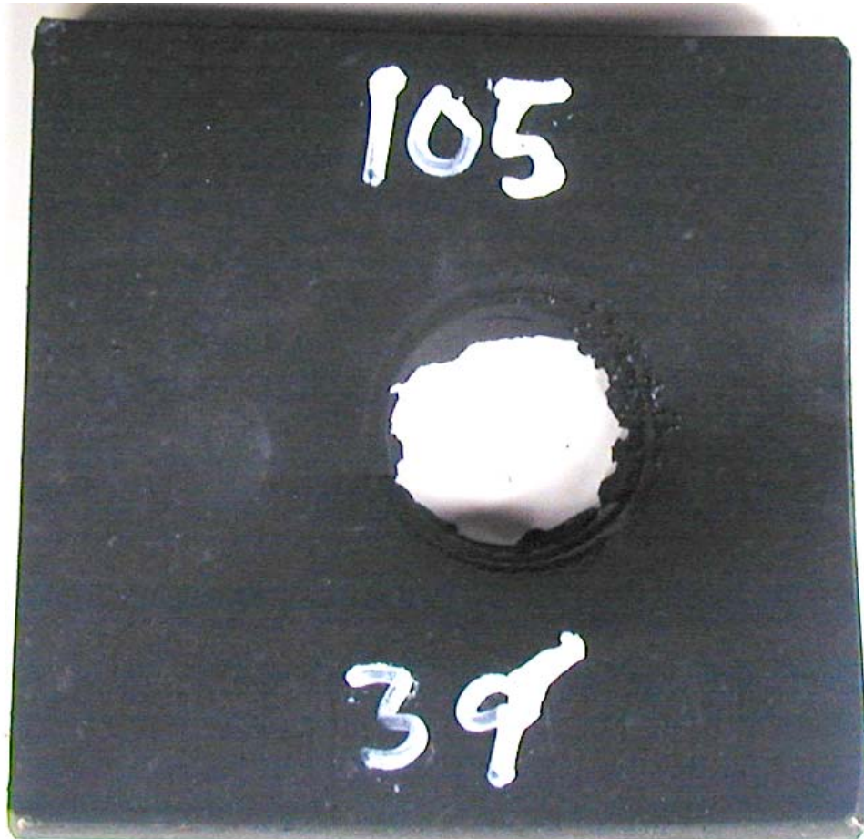
Figur 3.21 Skudd 1, rør nr 40 aldret ved 60°C i 3 mnd med PBXN-109, 105 kort, ikke omsatt.
