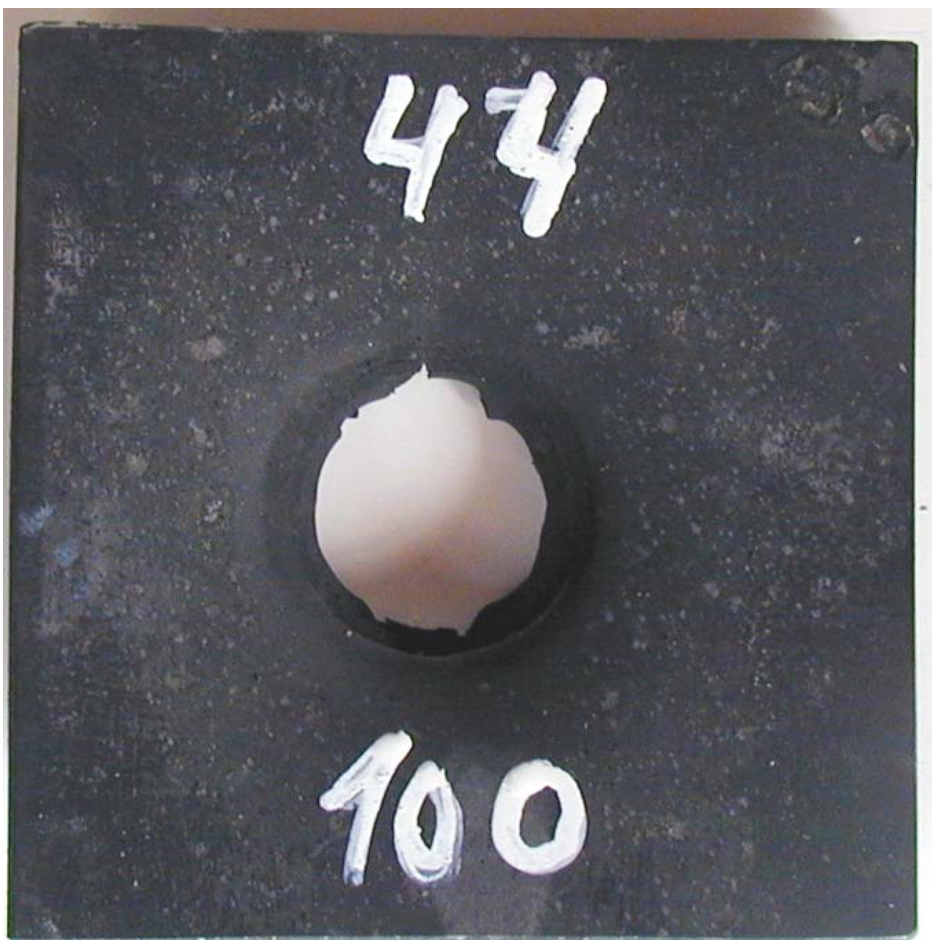
Figur 3.13 Skudd 4, rør 44 med PBXN-109, 100 kort omsatt.
