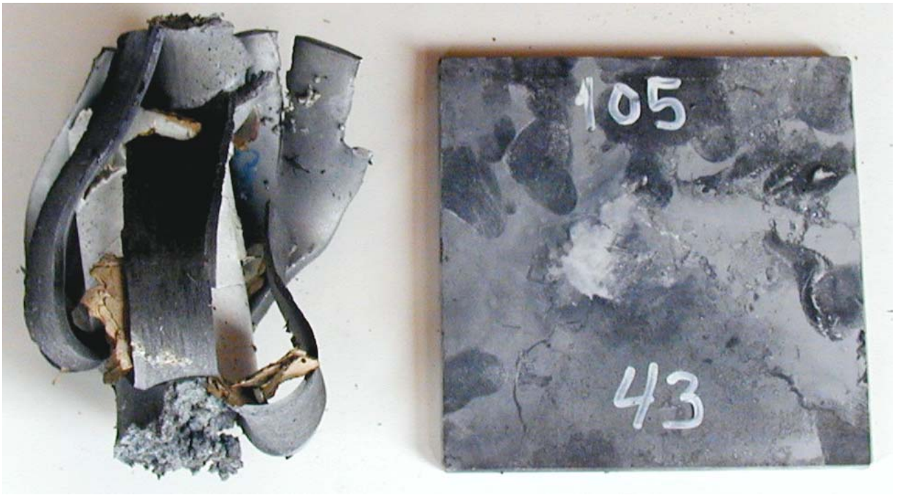
Figur 3.12 Skudd 3, rør 43 med PBXN-109, 105 kort, ikke omsatt.
