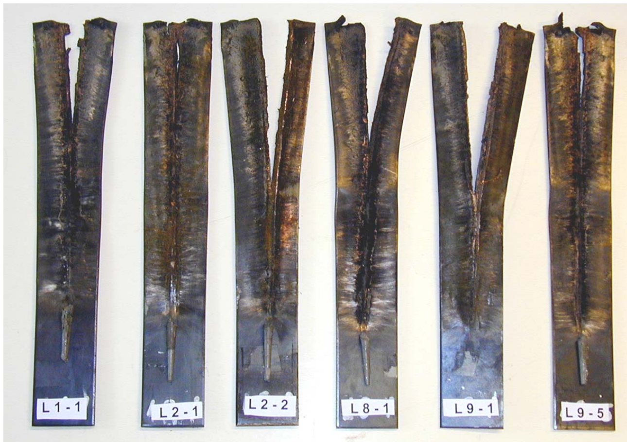
Figur 3.7 Bilde av vitneplatene samt igjenfunnet rester av sprengstoff konene for nyprodusert sprengstoff.
