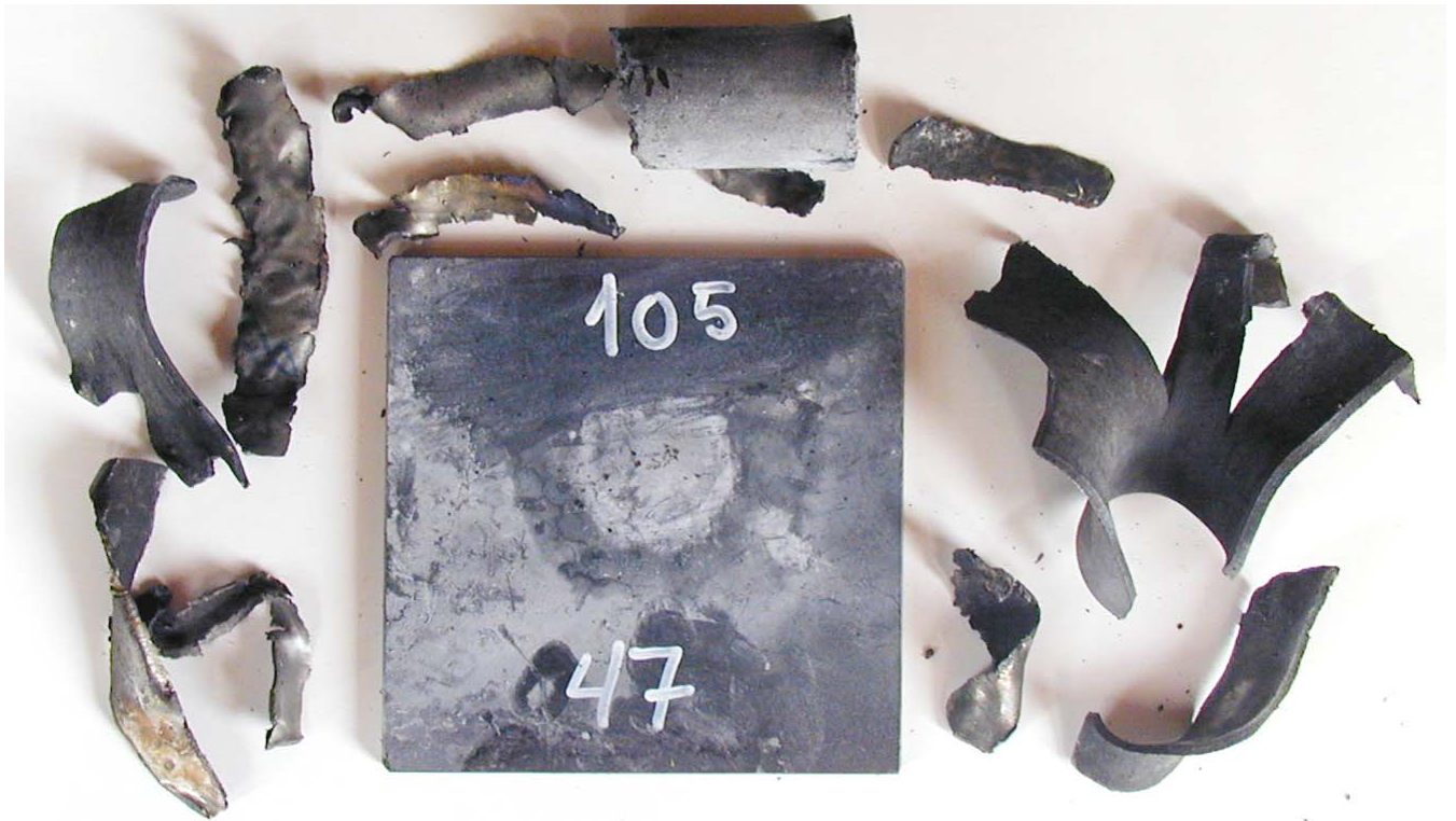
Figur 3.16 Skudd 7, rør 47 med PBXN-109, 105 kort, ikke omsatt.
