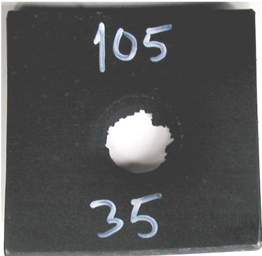
Figur 3.26 Skudd 6, rør 35 aldret ved 60°C i 3 mnd med PBXN-109, 105 kort, omsatt..
