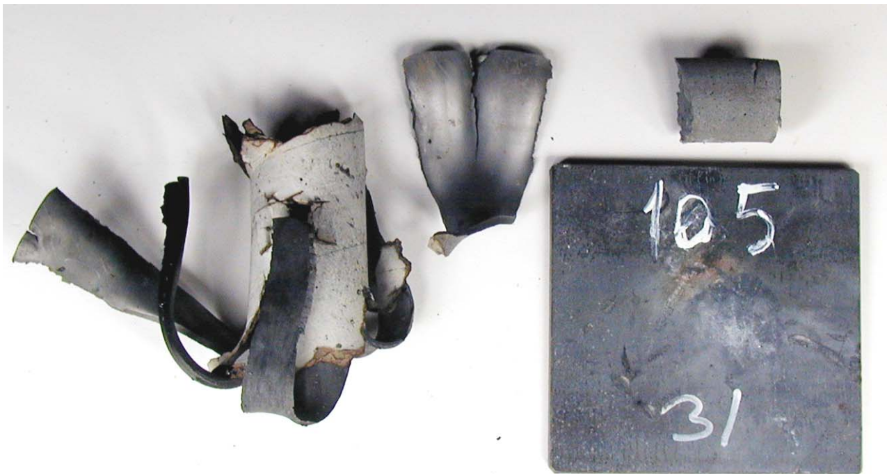
Figur 3.30 Skudd 10, rør 31 aldret ved 60°C i 3 mnd med PBXN-109, 105 kort, ikke omsatt.
