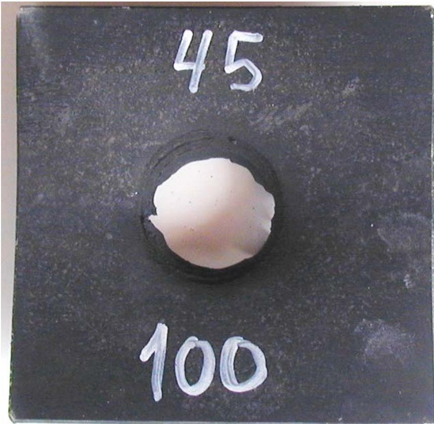
Figur 3.14 Skudd 5, rør 45 med PBXN-109, 100 kort, omsatt.
