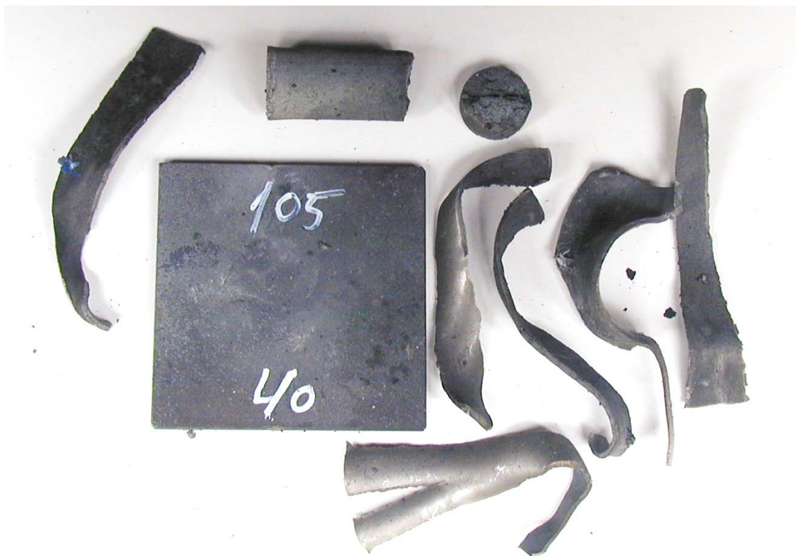
Figur 3.21 Skudd 1, rør nr 40 aldret ved 60°C i 3 mnd med PBXN-109, 105 kort, ikke omsatt.
