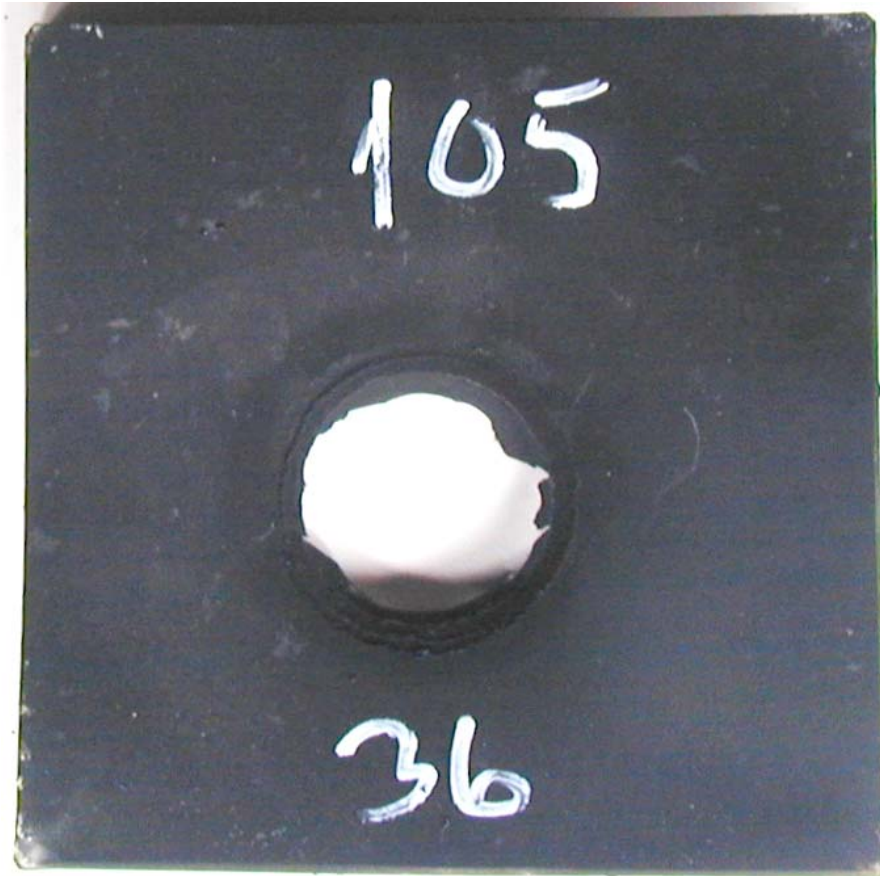
Figur 3.25 Skudd 5, rør 36 aldret ved 60°C i 3 mnd med PBXN-109, 105 kort, omsatt..
