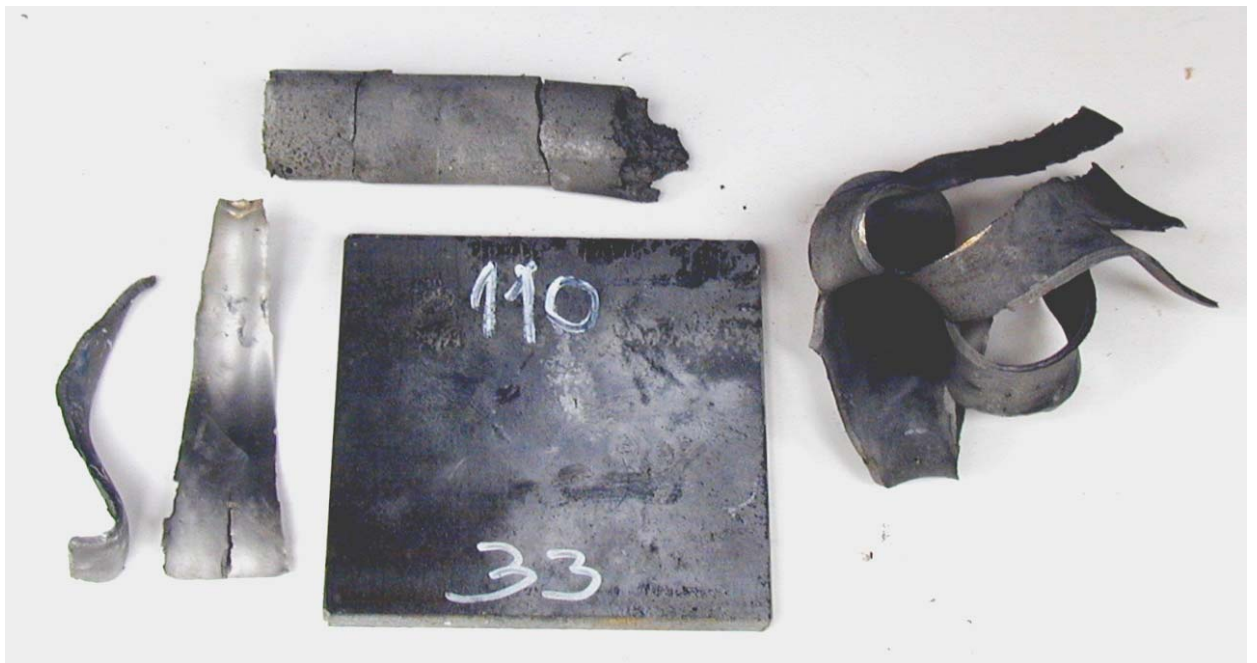
Figur 3.28 Skudd 8, rør 33 aldret ved 60°C i 3 mnd med PBXN-109, 110 kort, ikke omsatt.
