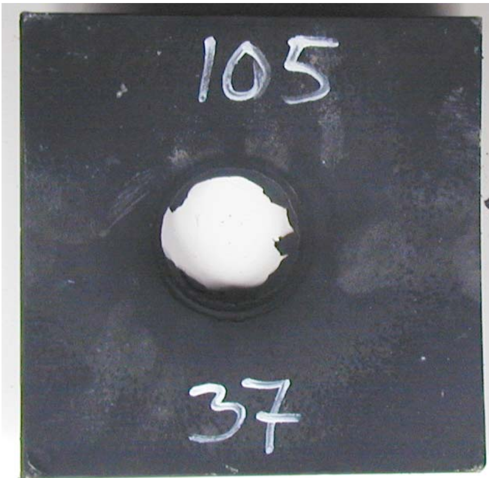
Figur 3.23 Skudd 3, rør 38 aldret ved 60°C i 3 mnd med PBXN-109, 105 kort, ikke omsatt.
