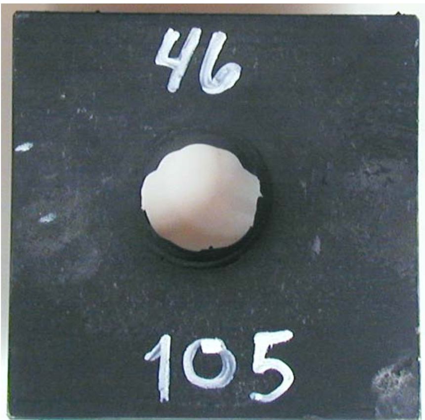
Figur 3.15 Skudd 6, rør 46 med PBXN-109, 105 kort, omsatt.
