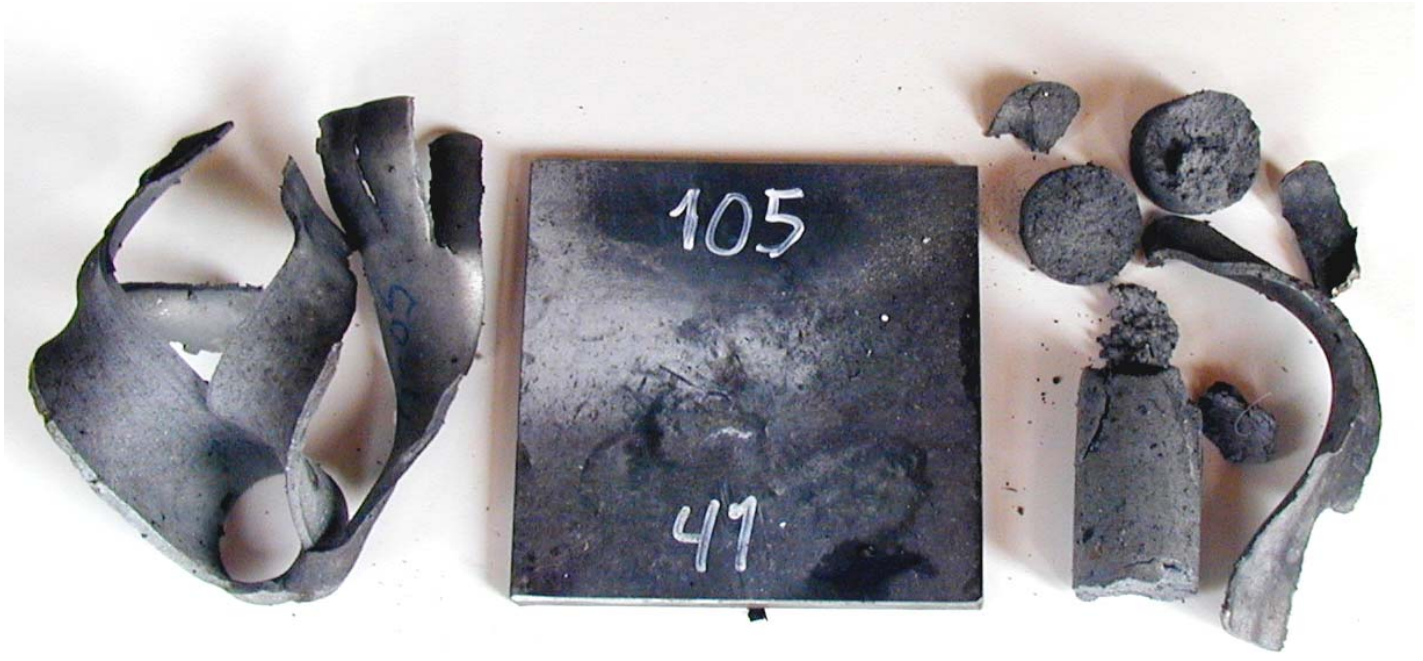
Figur 3.10 Skudd 1 rør 41 med PBXN-109, 105 kort, ikke omsatt.
