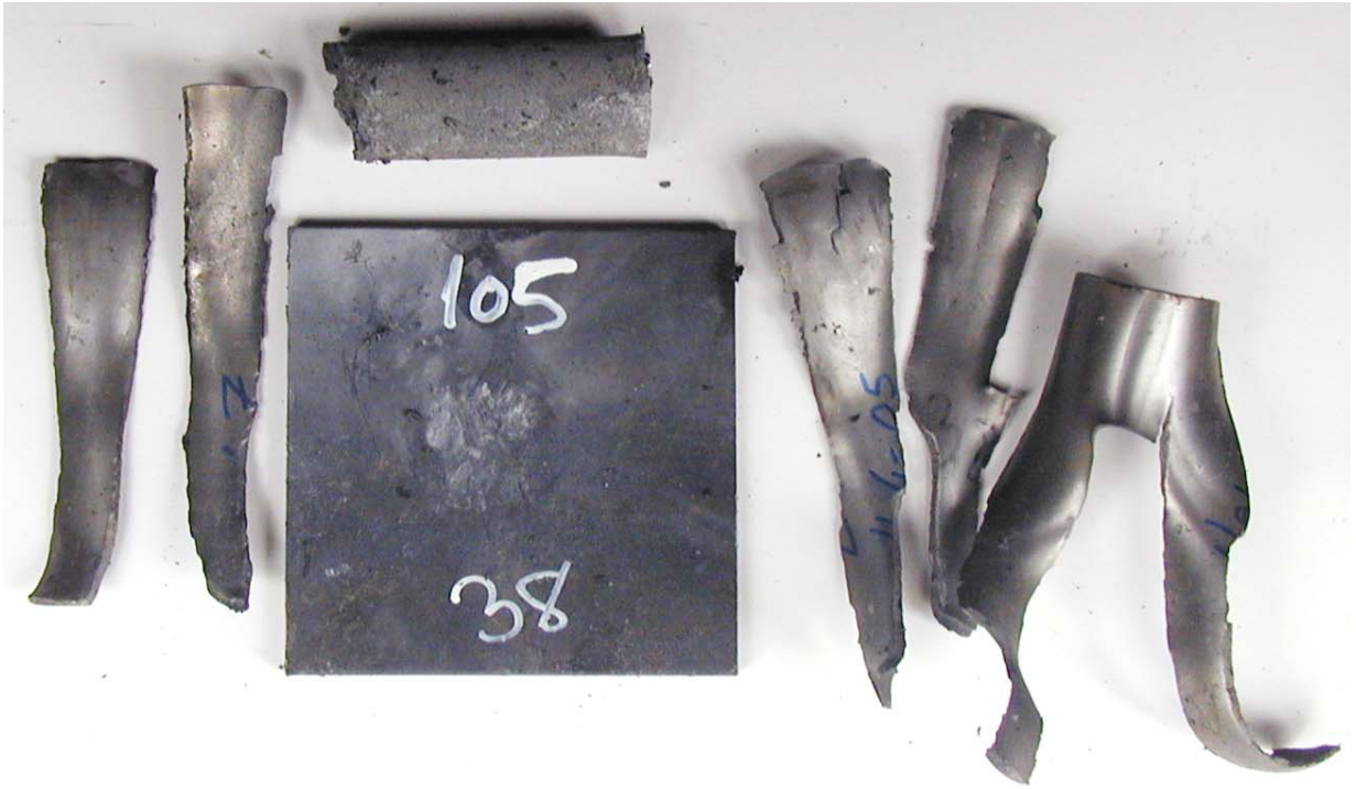
Figur 3.23 Skudd 3, rør 38 aldret ved 60°C i 3 mnd med PBXN-109, 105 kort, ikke omsatt.
