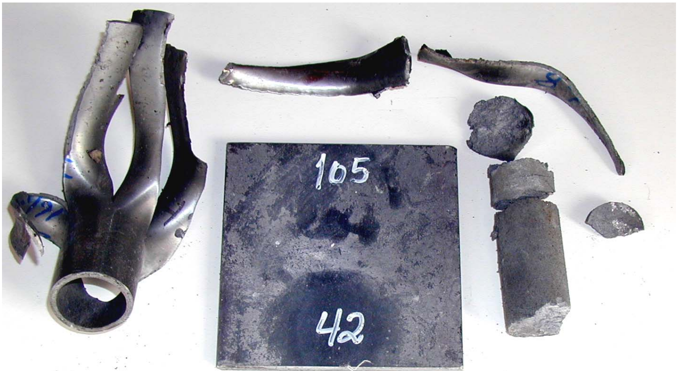
Figur 3.10 Skudd 1 rør 41 med PBXN-109, 105 kort, ikke omsatt.
