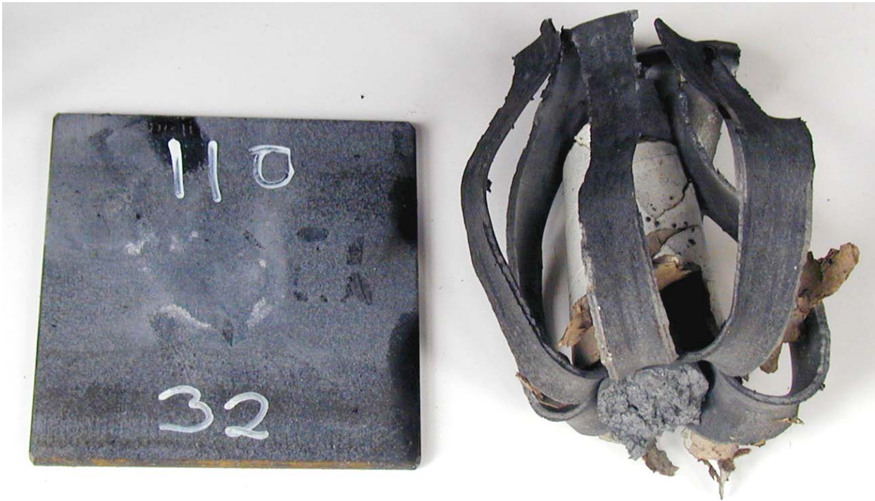
Figur 3.29 Skudd 9, rør 32 aldret ved 60°C i 3 mnd med PBXN-109, 110 kort, ikke omsatt.
