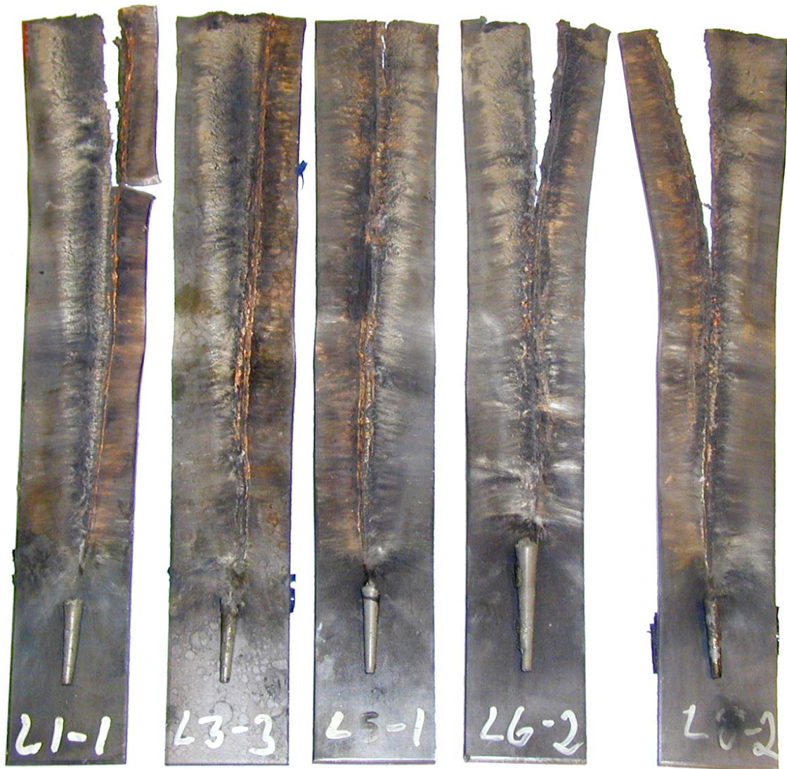
Figur 3.9 Bilde av vitneplater og sprengstoff rester etter fyring av PBXN-109 sprengstoffkoner aldret ved 60°C i 3 måneder.
