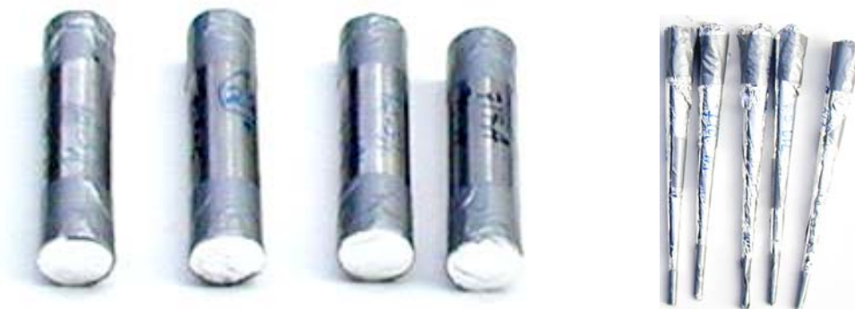
Figur 3.5 Bilder av hvordan Gaptestrør og kritiskdiameterkoner var pakket under aldringen.
