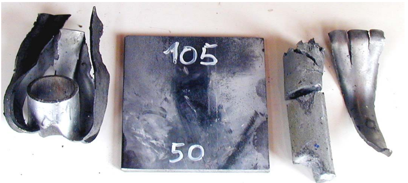
Figur 3.19 Skudd 10, rør 50 med PBXN-109, 105 kort, ikke omsatt.
