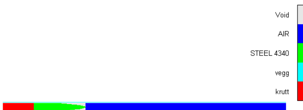
Figur 3-2: Initialtilstanden for simuleringen. Prosjektilet har en starthastighet på 300 m/s og kruttgassen har en lineært stigende hastighet fra 0 til 300 m/s
