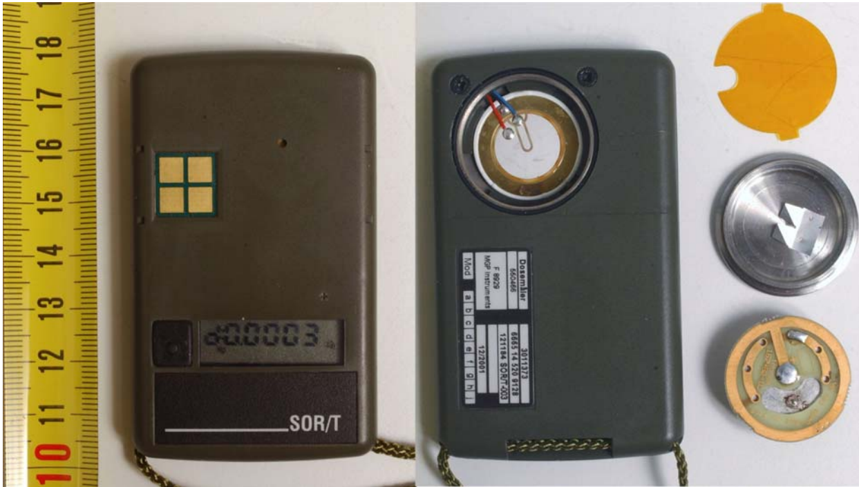
Figur 2.1 Dosemåler SOR/T-033 - forside og bakside (omtrent i skala 1:1). Batteriet er vist nede til høyre.
