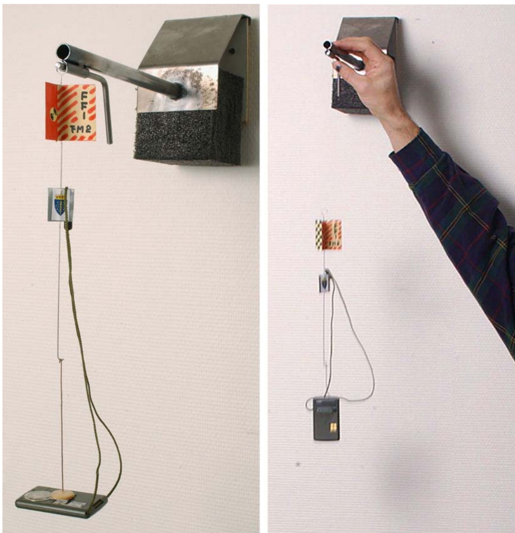
Figur 3.3 Oppheng av lett prøveholder og utløsning for fall. Til venstre ses prøveholder for anslag mot forside (horisontalt støt.) Til høyre anvendes prøveholder for anslag mot nedkant (vertikalt støt).
