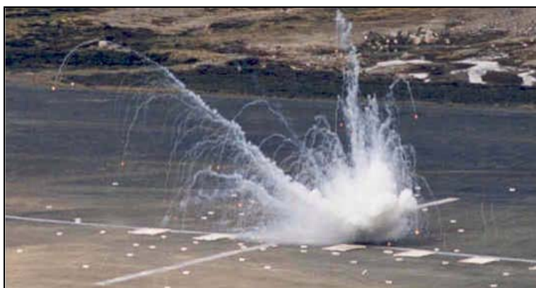
Figur 5.3 Detonasjon av bombekastergranat i feltforsøk på HFK-sletta. Foto tatt fra helikopter et halvt sekund etter detonasjon (øverst). Foto tatt fra Edvinbu et halvt sekund og to sekunder etter detonasjon (midten og nederst)
