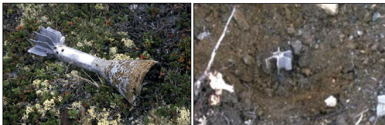
Figur 5.14 Haleparti fra bombekastergranat tatt opp fra krater (til venstre). Haleparti presset ned i krater (til høyre)
