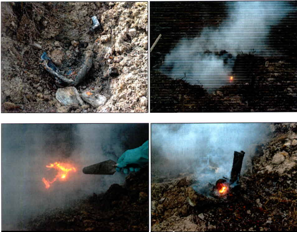
Figur 5.33 Bit av hvitt fosfor i krater etter detonasjon av artillerigranat som selvantenner når den tas opp og blir eksponert for luft
