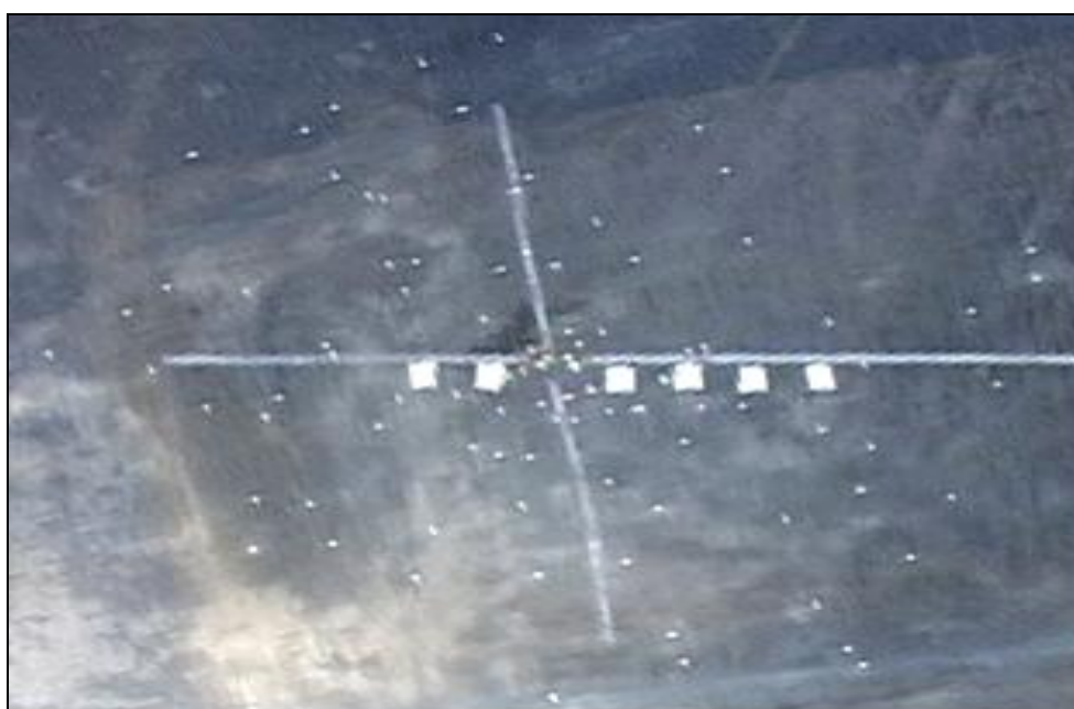
Figur 3.4 Bilde fra helikopter som viser hvordan plastkar, presenningsbasseng og plastfolie var utplassert i forsøksområdet
