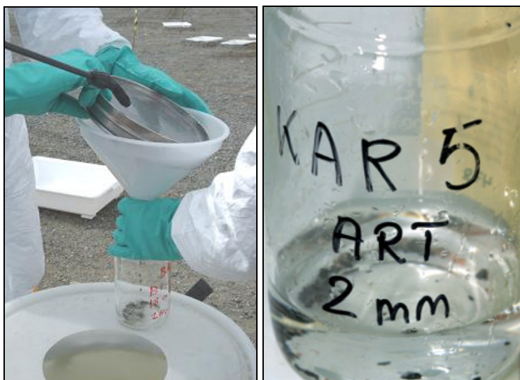
Figur 3.8 Overføring av oppsamlet materiale i siktene til glassflasker som ble fylt med vann
