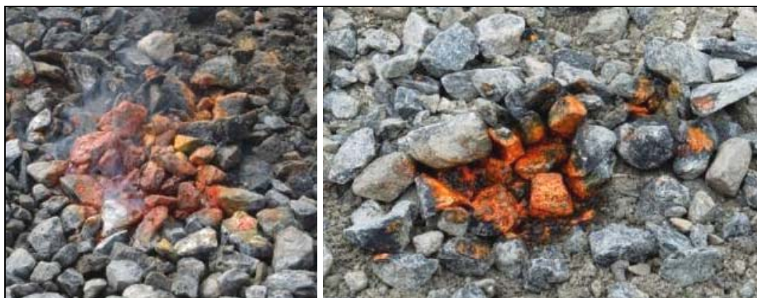
Figur 5.26 Den brennende massen av hvitt fosfor som lander på bakken er nærmest flytende og blir klint utover bakken. Den orange fargen skyldes at rødt fosfor dannes som restprodukt ved forbrenningen av hvitt fosfor
