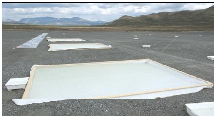
Figur 3.2 Utformingen av presenningsbasseng med størrelse 4 x 5 m
