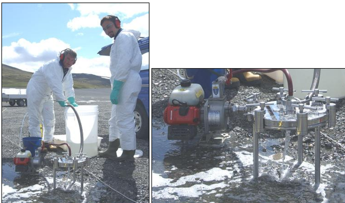
Figur 3.9 Filtrering av restinnholdet som har gått gjennom sikten på 0,10 mm
