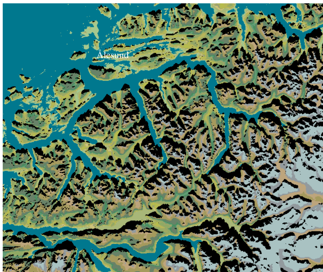
Figur F.2 Dekningsdiagrammet viser fjellskyggen (svarte felt) på Nordvestlandet ved bruk av GEO satellitt på 1°W.
